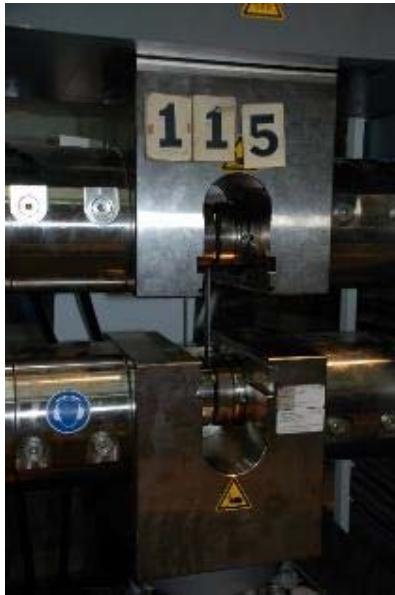
15. ábra - Szakítószilárdság mérése a Zwick gépben
