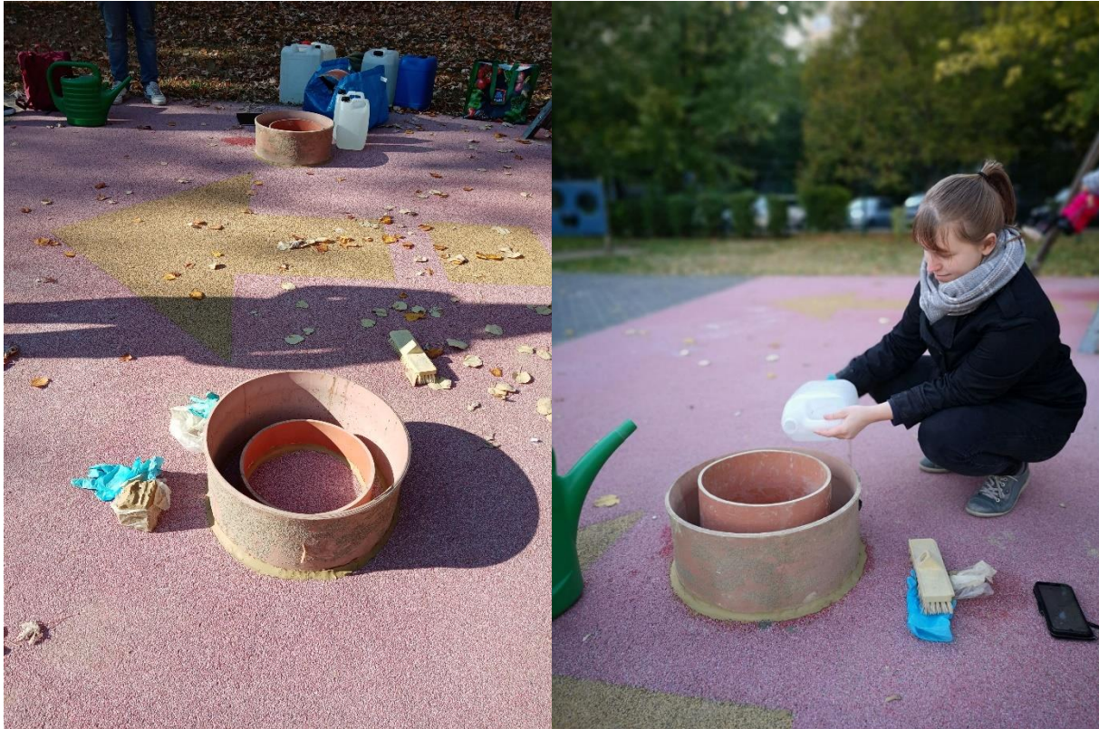
10. ábra A dupla gyűrűs infiltrométer és a mérési folyamat szimpla- és dupla gyűrűs mérések esetében
