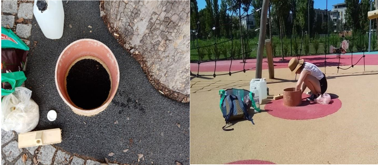
9. ábra Mérőeszközök és a mérés folyamata szimpla gyűrűs mérési módszer esetében
