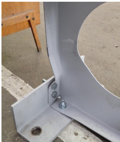
31. ábra: az első próbatest tönkremenetele; a másik oldalon szimmetrikusan ugyanez látható. Éles szemmel kiszúrható, hogy a próbatest sarkánál a festék egy nagyjából 30°-os szögben emelkedő vonal mentén felgyűrődött, ez a sarok jelentős mértékű képlékeny alakváltozására, feszültségkoncentrációra utal.
