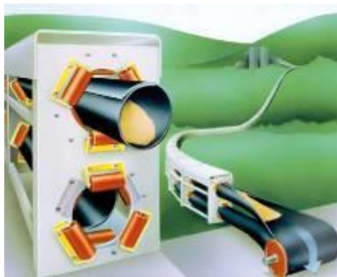
3. ábra: egy csőhevederes szállítószalag szerkezete (BEUMER) (6)
