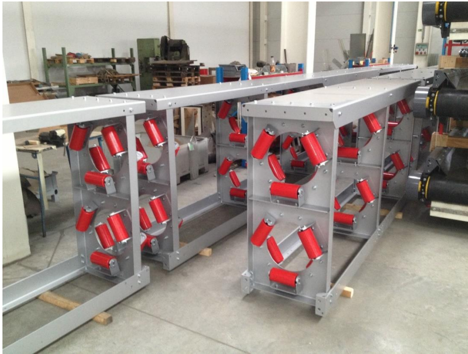
5. ábra: a támasz fölötti háromelemes modul jobbra, kételemes pályamenti modulok balra, összeszerelés közben, ferde rácsrudak nélkül. (13)
