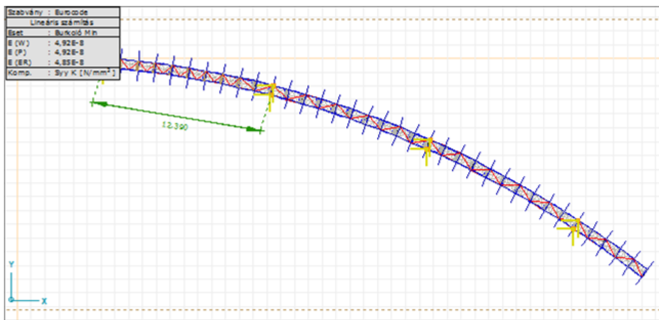
7. ábra: rúdszerkezeti modell, felülnézet
