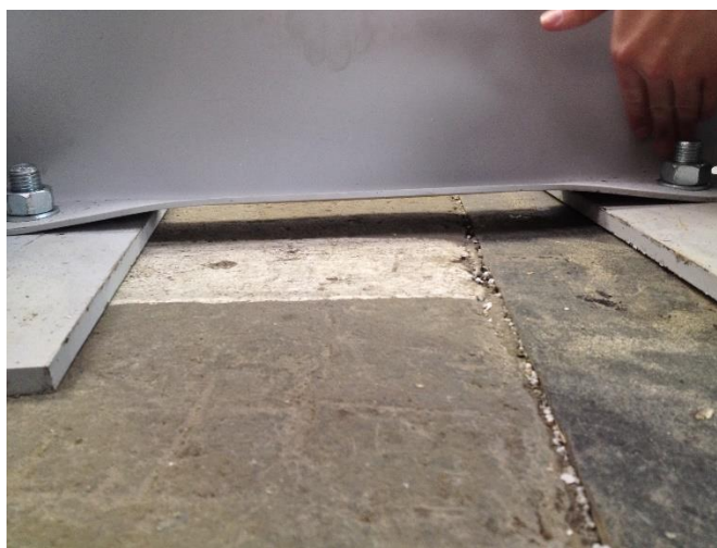
28. ábra: a deformálódott alsó él; a mérési pontokat tartalmazó felső élen valamivel kisebb, de ilyen jellegű deformáció figyelhető meg.
