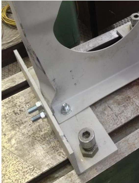
32. ábra: a második próbatest tönkremenetele. Látható, hogy a gyenge keresztmetszet is jelentősen deformálódott.
