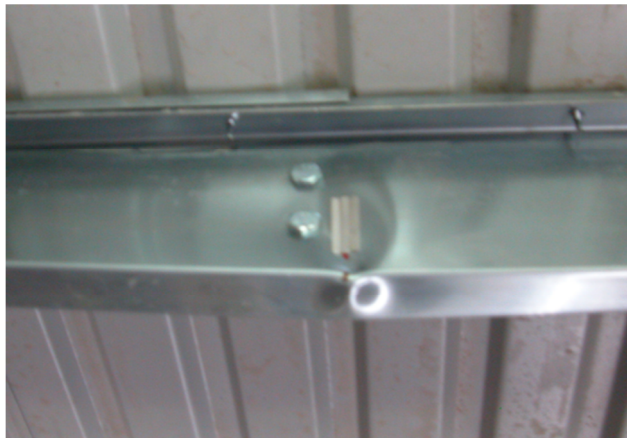
9. kép és 37. ábra: Z150 szelemen valós illetve numerikus tönkremenetele, átlapolásnál
