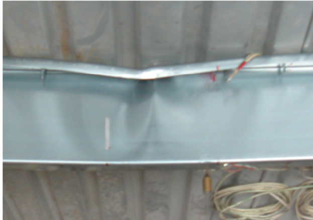
6. kép és 19. ábra: Z150 szelemen valós illetve numerikus tönkremenetele mezőközépen
