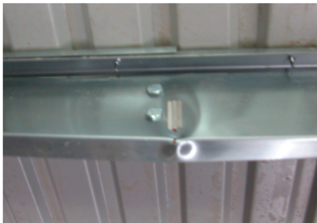
9. kép és 43. ábra: Z150 szelemen valós illetve numerikus tönkremenetele, átlapolásnál
