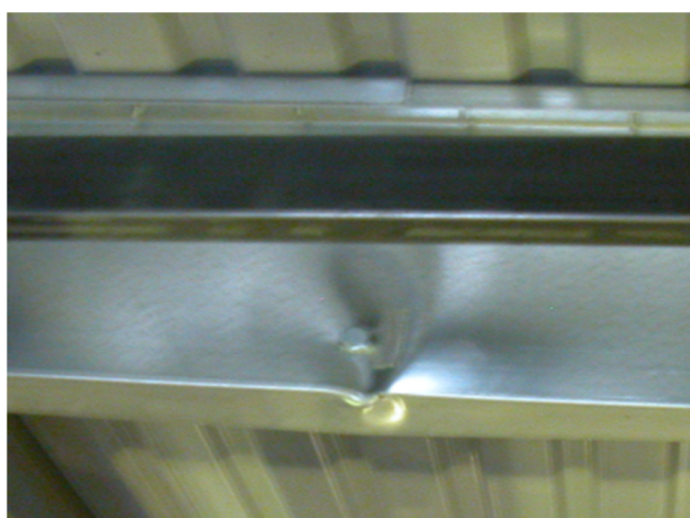
11. kép és 45. ábra: Z250 szelemen valós illetve numerikus tönkremenetele, átlapolásnál
