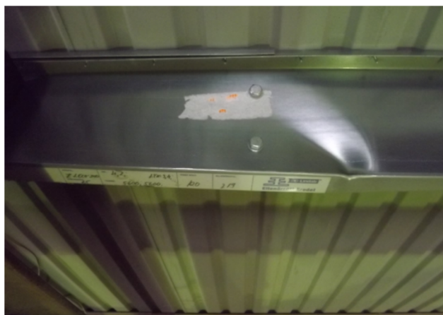
10. kép és 44. ábra: Z200ECO szelemen valós illetve numerikus tönkremenetele, átlapolásnál
