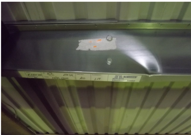
10. kép és 26. ábra: Z200ECO szelemen valós illetve numerikus tönkremenetele, átlapolásnál
