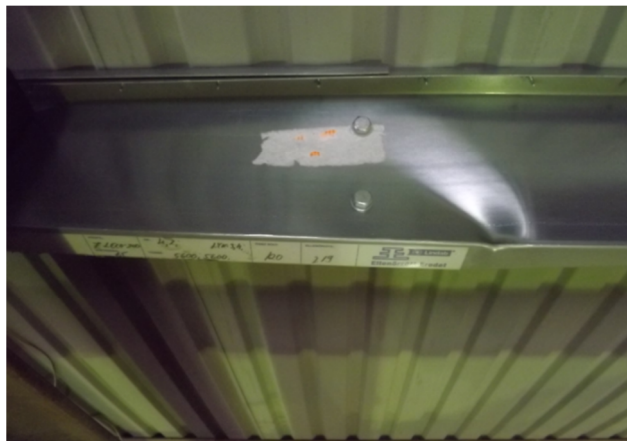
10. kép és 38. ábra: Z200ECO szelemen valós illetve numerikus tönkremenetele, átlapolásnál
