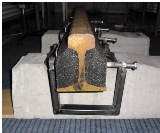
3.26. ábra – Granuflex kamraelem vizsgálati elrendezése 60 E1-es sínrendszeren [saját fotó]
