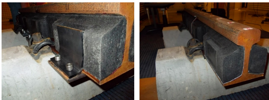
3.25. ábra – Sofidon-T típusú kamraelem kétféle rögzítési módszerrel felhelyezve 60E1 rendszerű sínszálra [saját fotó]
