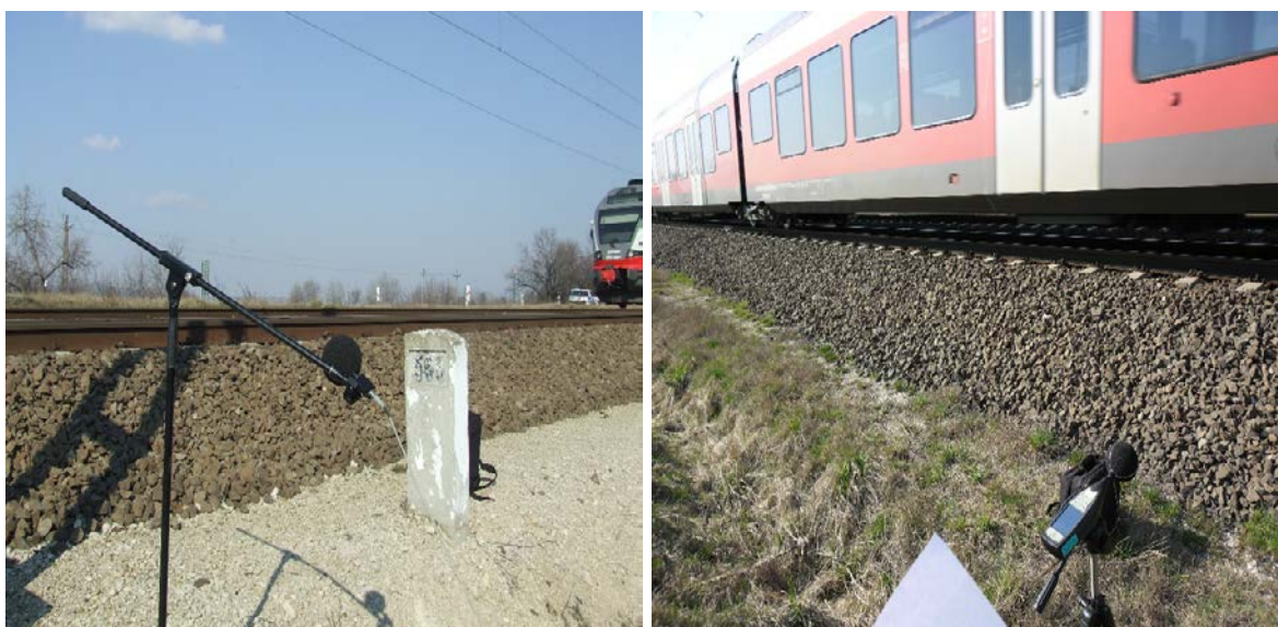
5.23. ábra – A csillapítatlan (balra) és csillapított vágány (jobbra) melletti mérőhely [saját fotó]
