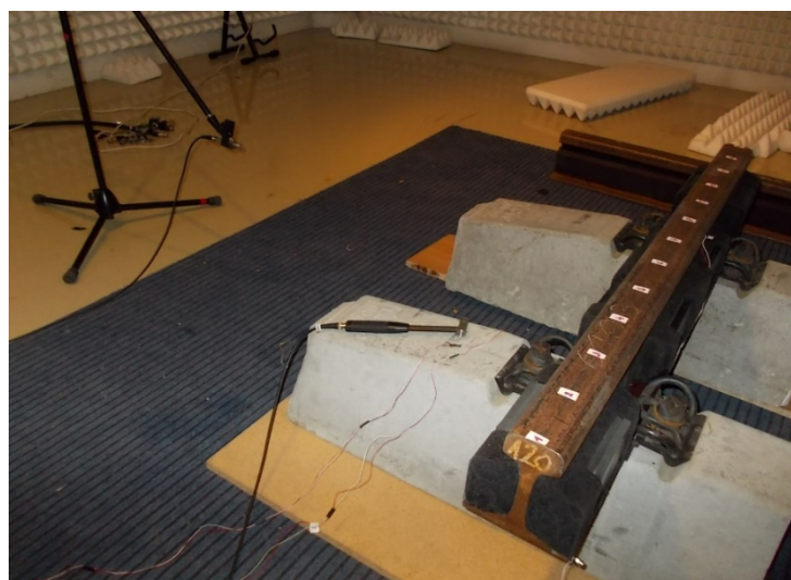
4.2. ábra – A mérési rendszertől 1 méter távolságra elhelyezett mikrofon [saját fotó]
