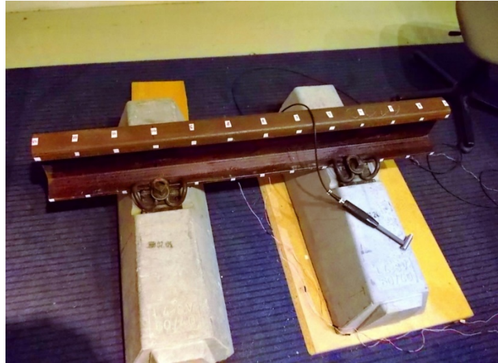
4.1 ábra – A laboratóriumban összeállított rendszer, a mérés összehasonlításának alapját képező csillapítatlan sínszál. Láthatók a sínszálon felcímkézett gerjesztési pontok és a mérések során használt eszközök: az impulzuskalapács, valamint a rezgésérzékelők. [saját fotó]
