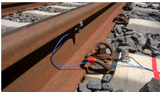
5.4. ábra – Sínfej alatt és keresztaljon elhelyezett rezgésérzékelők (Szabadifürdő) [28]
