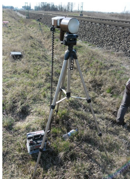
5.24. ábra – Radaros sebességmérő műszer [saját fotó]
