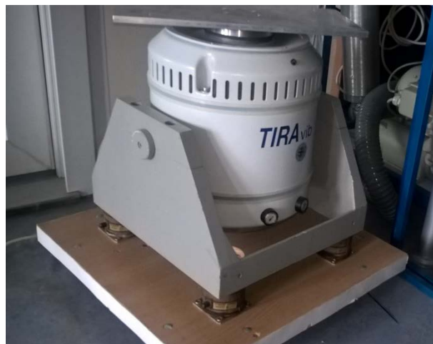
6.3. ábra – TIRAvib 5220 típusú elektrodinamikus rezgésgerjesztő (shaker) [Dr. Augusztinovicz Fülöp fotója]
