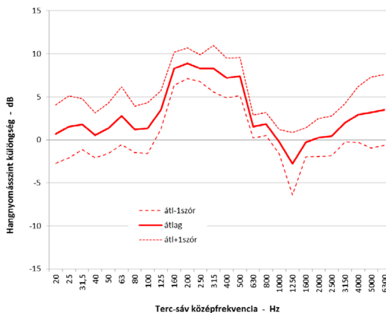
5.14. ábra – Aljpacucs beépítésének hatása az átlagos hangnyomásszintekre [28]
