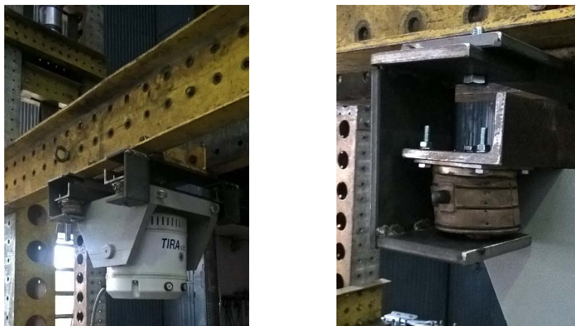
6.6. ábra – Az elektrodinamikus rezgésgerjesztő (shaker) felfüggesztése
