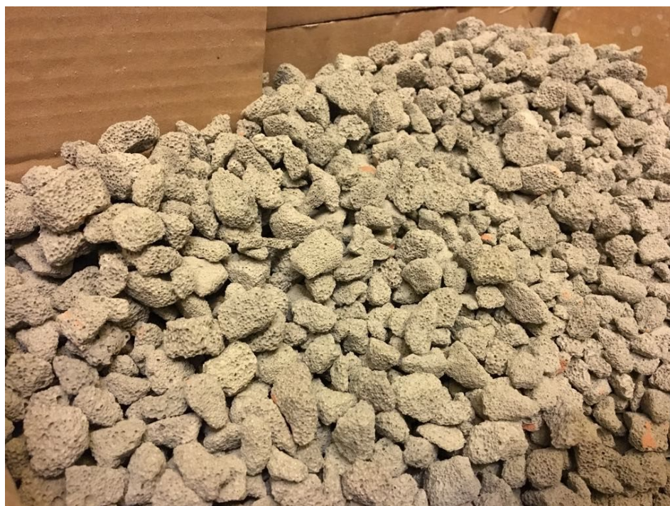
1.ábra: Az általam vizsgált üveghab granulátum
