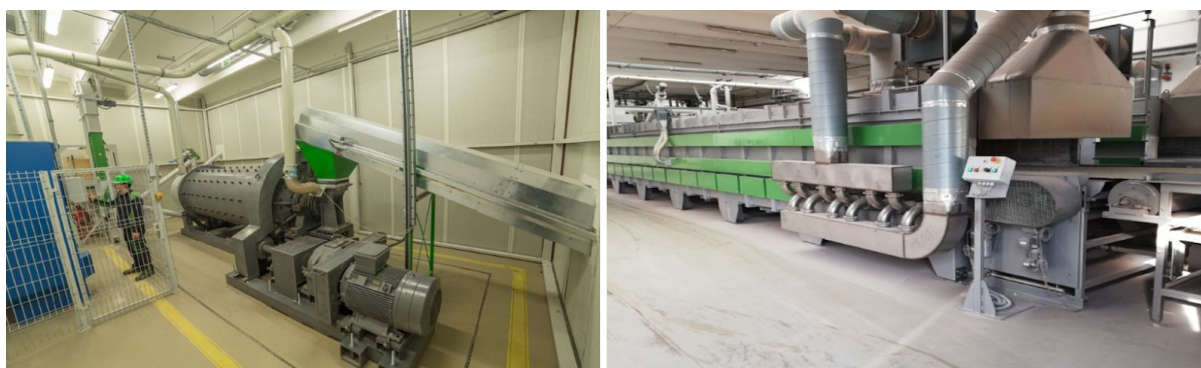
2. ábra: Üveghulladék őrlésére szolgáló szerkezet (balra) és üveghab kemence (jobbra)
