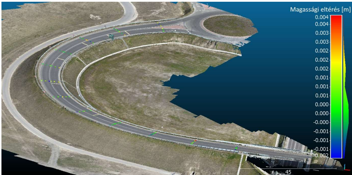
14. ábra 10 illesztőpont használatával előállított pontfelhő eltérései
