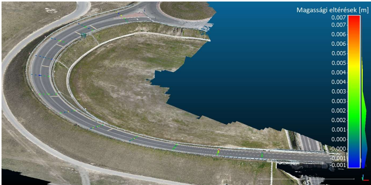
9. ábra Agisofttal szoftverrel készített pontfelhő kiértékelése
