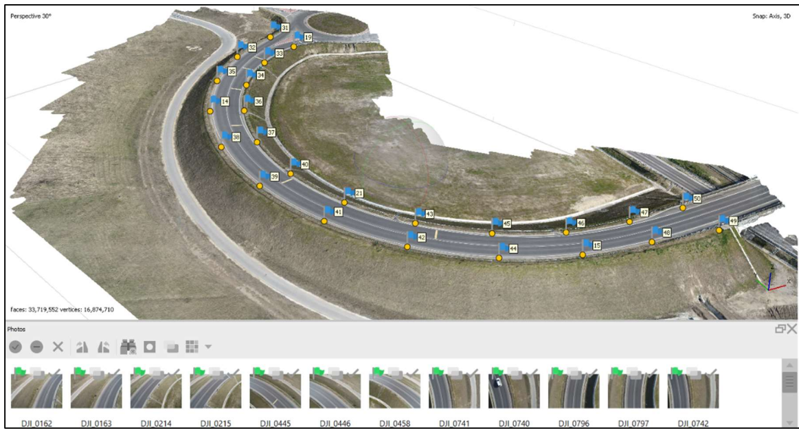
6. ábra Sűrű pontfelhő illesztőpontokkal
