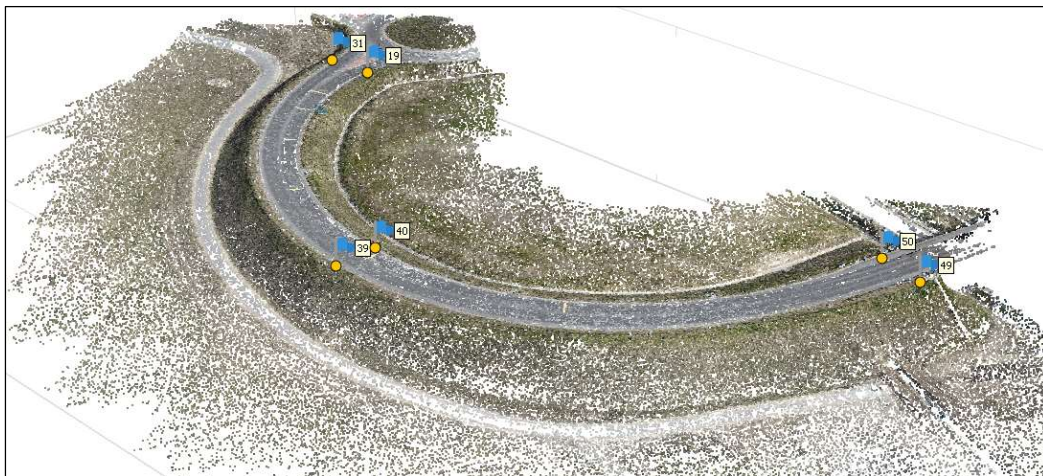
15. ábra Illesztőpontok minimalizálása
