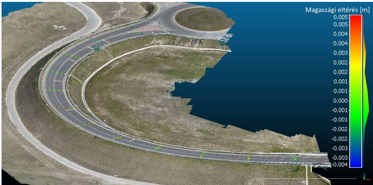
16. ábra Minimális illesztőpont használatával kapott pontfelhő eltérései
