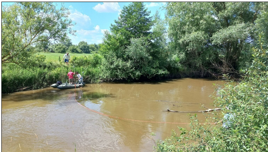
4. ábra: Szelvénymenti mérések ADCP-vel felszerelt hajóval.
