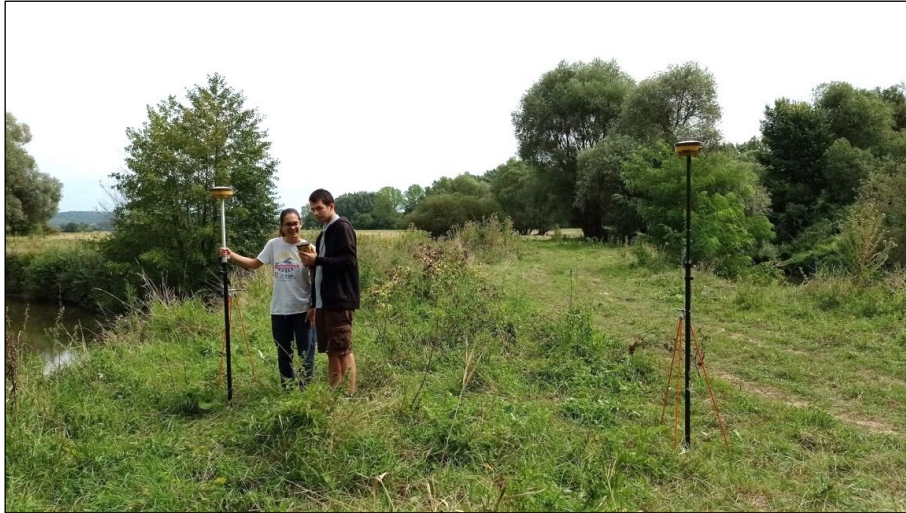
5. ábra: A Topcon műszerek használata, ahol a bázist növényzettől mentes helyen állítottuk fel, így a rover vevővel a sűrűbb növényzetű területeken is lehetett méréseket végezni.
