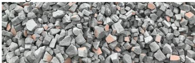
18. ábra - Üveghab granulátum hőszigetelő feltöltés [16]
