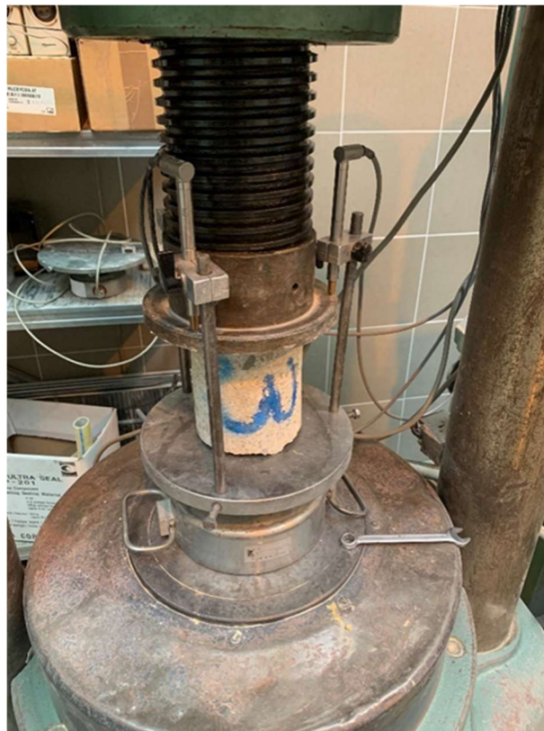
8. kép: Egyirányú nyomóvizsgálat (saját kép)
