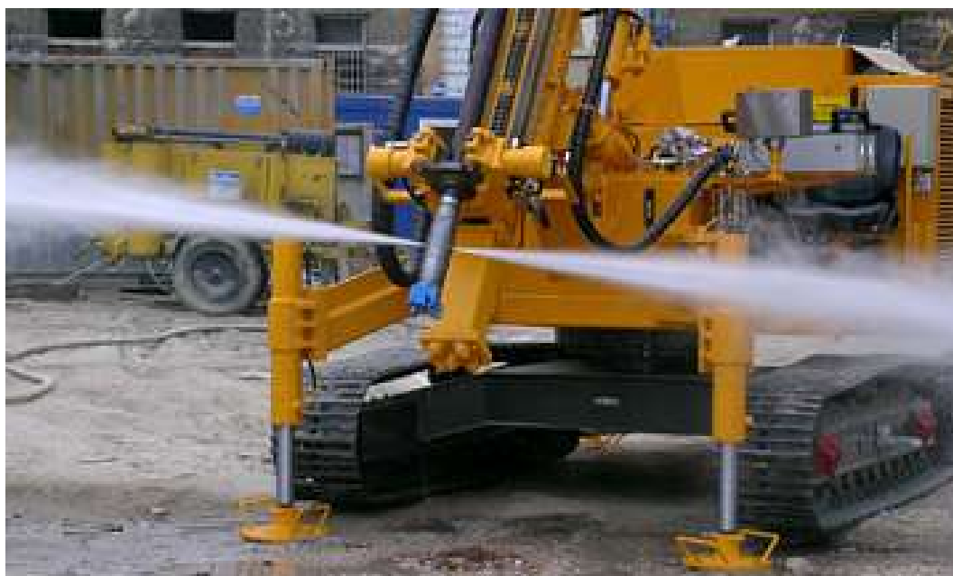
1. kép: 400 bar nyomású vízsugár [3]
