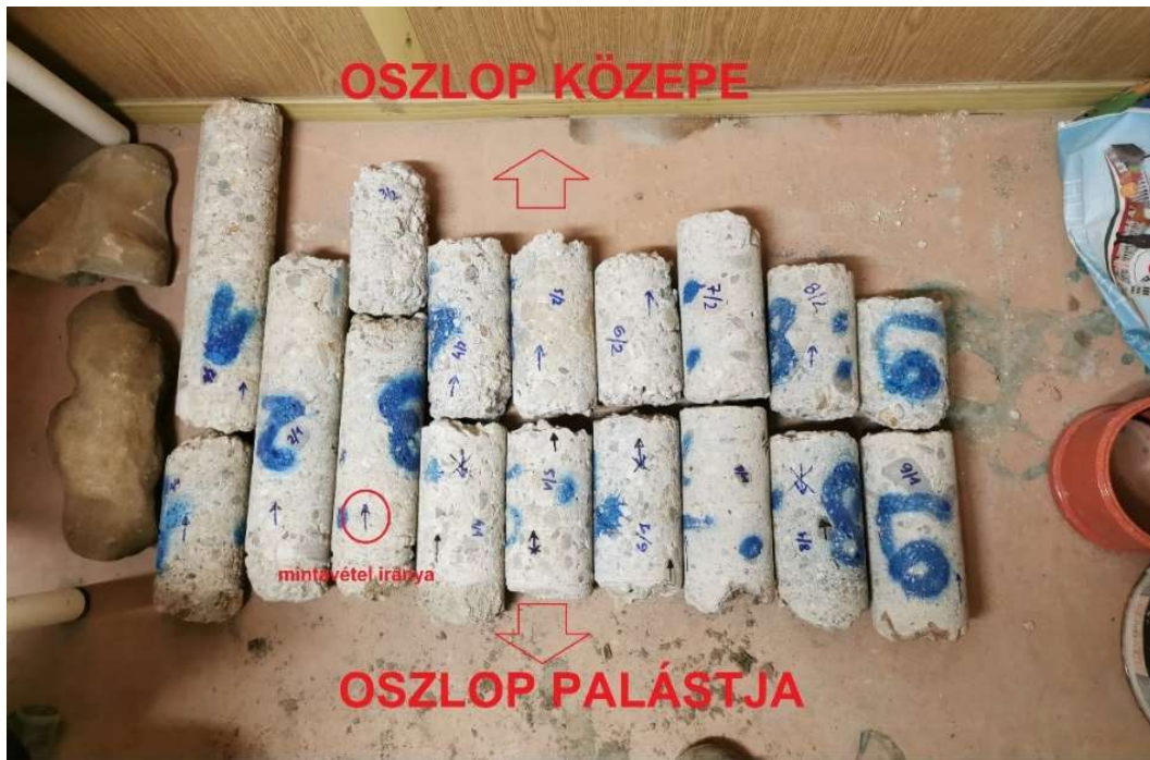
5. kép: Mintavételezett próbatetek (saját kép)
