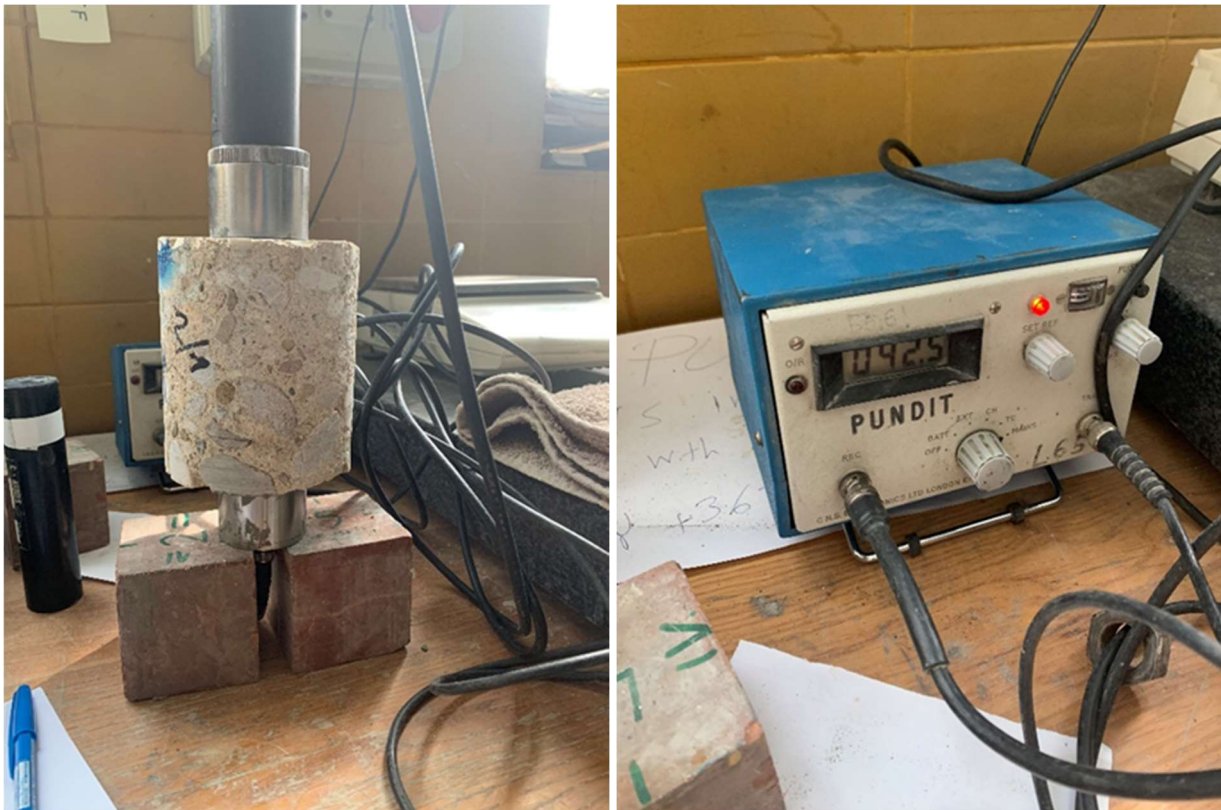
7. kép: Ultrahang terjedési sebesség vizsgálat (saját kép)
