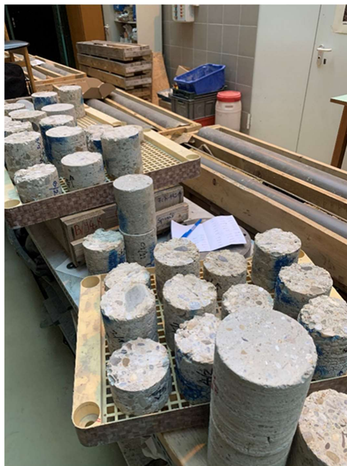
6. kép: Kiszáritott próbatetek a laboratóriumban (saját kép)
