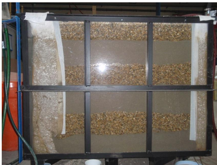
4.1. kép Kismintamodell oldalnézetből, hat rétegben beépített anyaggal
