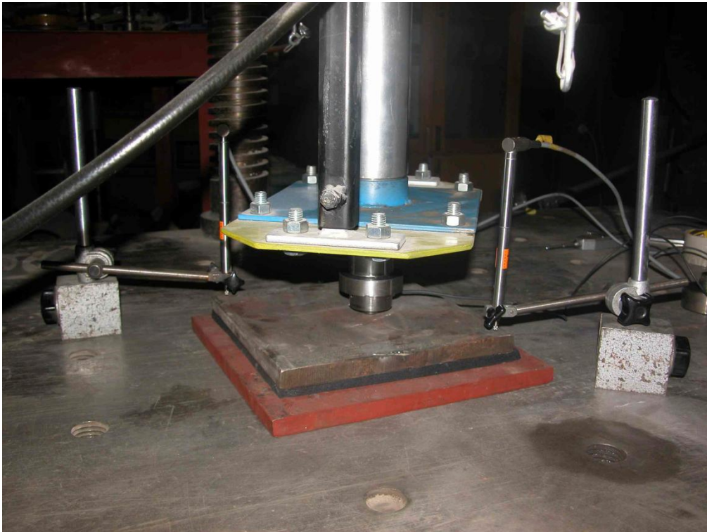
6. kép: 12 mm vastag DV-SILENT A típusú gumilemez statikus terhelése
