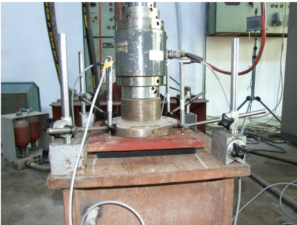
11. kép: A dinamikus fárasztás során 4 db induktív úradó mérte az elmozdulásokat
