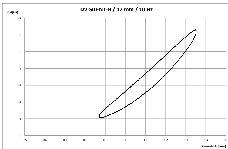
68. ábra: A DV-SILENT-B típusú gumilemez dinamikus rugalmasság-vizsgálata során felvett erő-elmozdulás diagramok (12 mm vastagság esetén, 10 Hz terhelési frekvencián)
