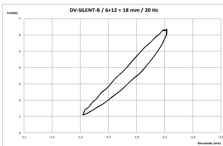
64. ábra: A DV-SILENT-B típusú gumilemez dinamikus rugalmasság-vizsgálata során felvett erő-elmozdulás diagramok (6 + 12 = 18 mm vastagság esetén, 20 Hz terhelési frekvencián)
