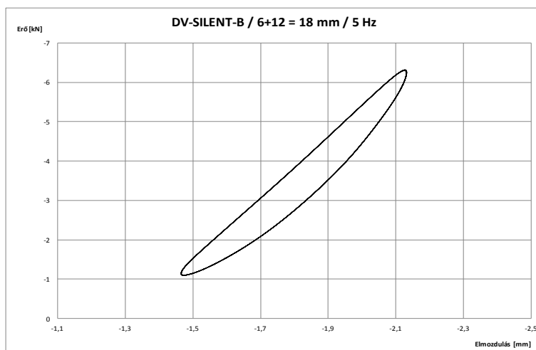
62. ábra: A DV-SILENT-B típusú gumilemez dinamikus rugalmasság-vizsgálata során felvett erő-elmozdulás diagramok (6 + 12 = 18 mm vastagság esetén, 5 Hz terhelési frekvencián)
