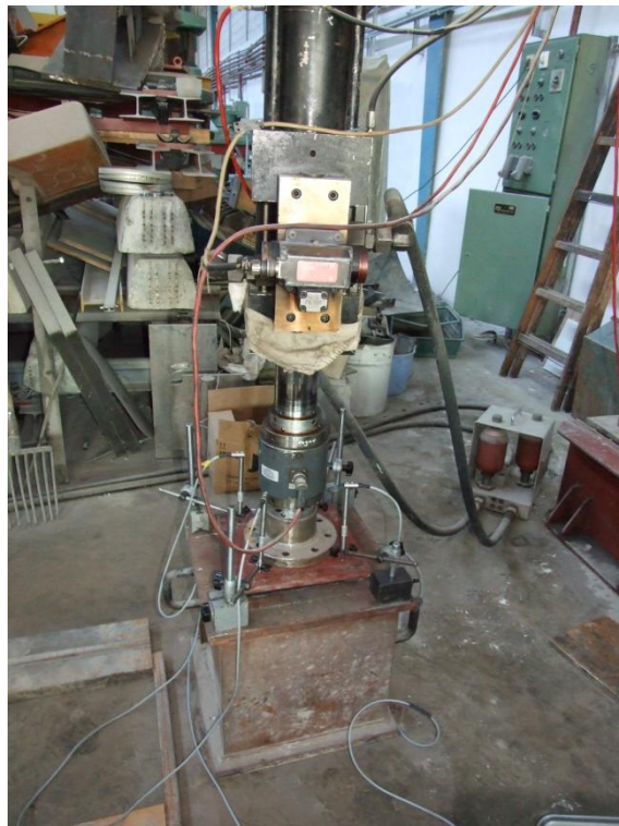
13. kép: MTS fárasztógép, mérés közbeni állapot (II.)
