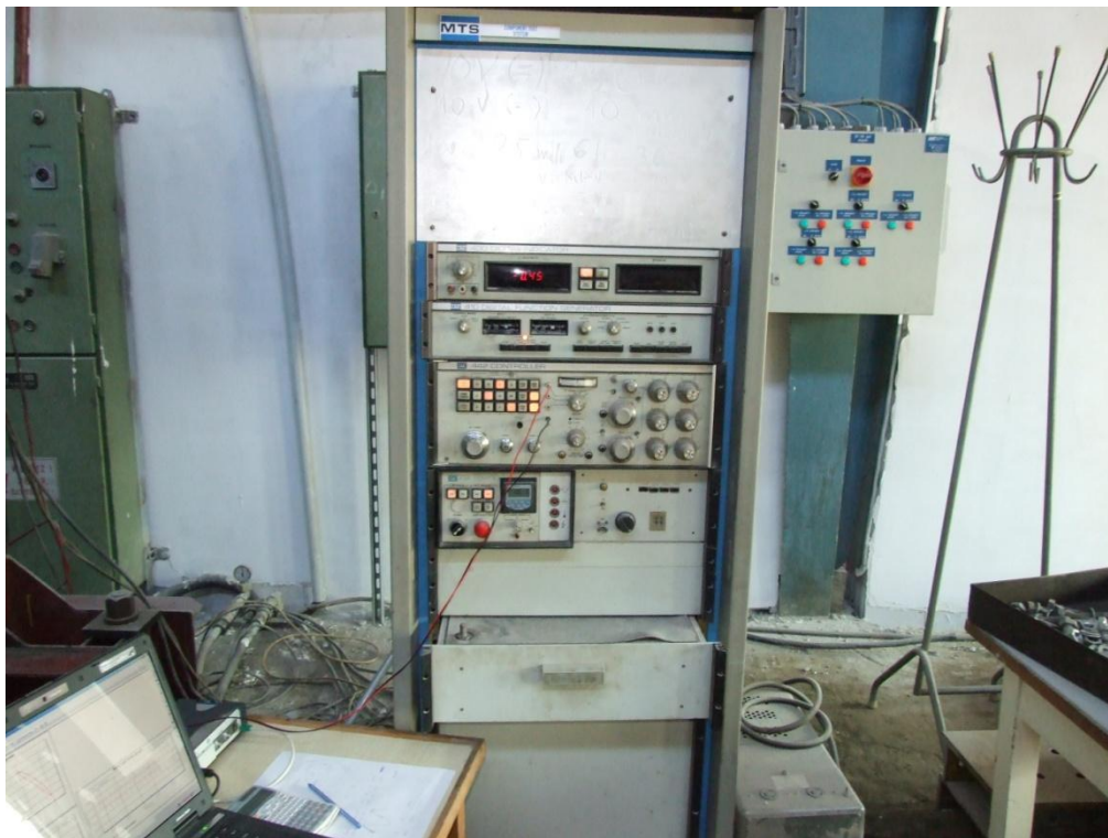
9. kép: MTS típusú fárasztógép (BME Út és Vasútépítési Tanszékének laboratóriuma)
