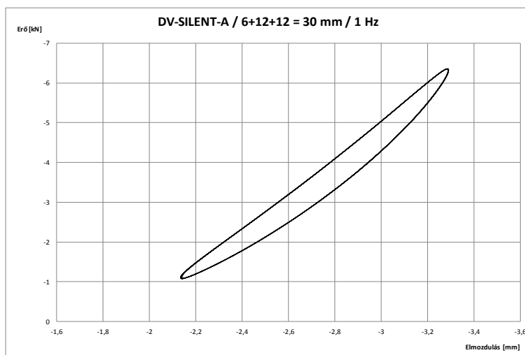
47. ábra: A DV-SILENT-A típusú gumilemez dinamikus rugalmasság-vizsgálata során felvett erő-elmozdulás diagramok (6 + 6 +12 = 30 mm vastagság esetén, 1 Hz terhelési frekvencián)
