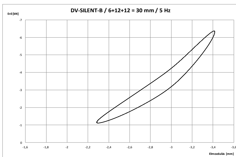
76. ábra: A DV-SILENT-B típusú gumilemez dinamikus rugalmasság-vizsgálata során felvett erő-elmozdulás diagramok (6 + 12 + 12 = 30 mm vastagság esetén, 5 Hz terhelési frekvencián)
