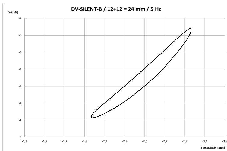
72. ábra: A DV-SILENT-B típusú gumilemez dinamikus rugalmasság-vizsgálata során felvett erő-elmozdulás diagramok (12 + 12 = 24 mm vastagság esetén, 5 Hz terhelési frekvencián)
