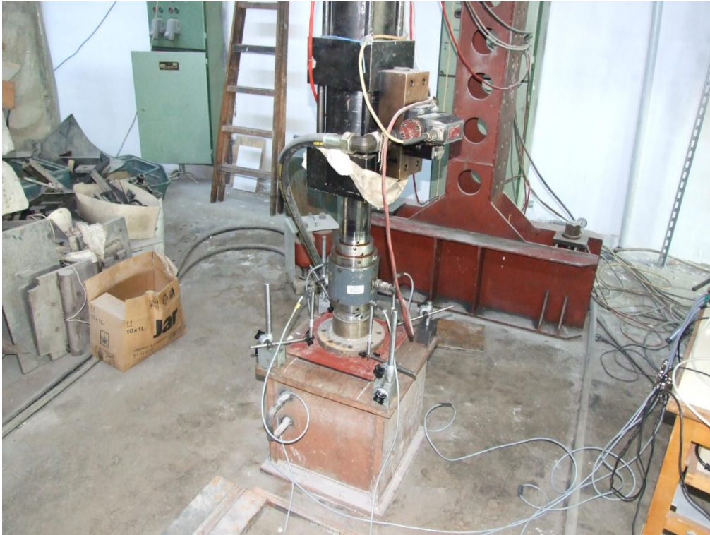
10. kép: MTS fárasztógép, mérés közbeni állapot (I.)
