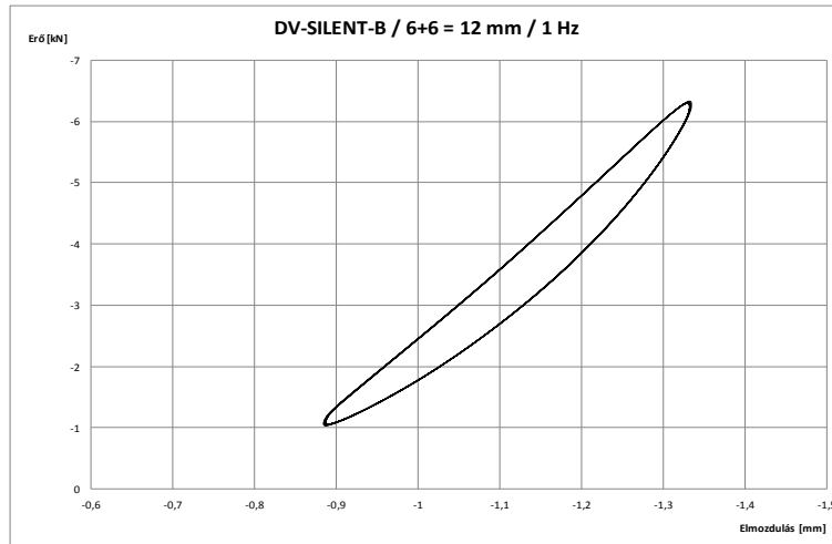
56. ábra: A DV-SILENT-B típusú gumilemez dinamikus rugalmasság-vizsgálata során felvett erő-elmozdulás diagramok (6 + 6 = 12 mm vastagság esetén, 1 Hz terhelési frekvencián)
