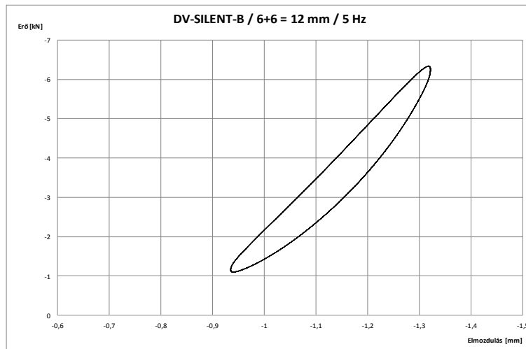
57. ábra: A DV-SILENT-B típusú gumilemez dinamikus rugalmasság-vizsgálata során felvett erő-elmozdulás diagramok (6 + 6 = 12 mm vastagság esetén, 5 Hz terhelési frekvencián)
