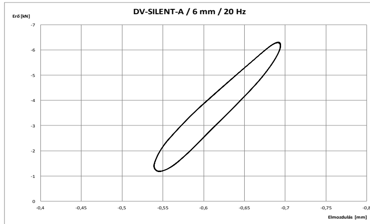
26. ábra: A DV-SILENT-A típusú gumilemez dinamikus rugalmasság-vizsgálata során felvett erő- elmozdulás diagramok (6 mm vastagság esetén, 20 Hz terhelési frekvencián)
