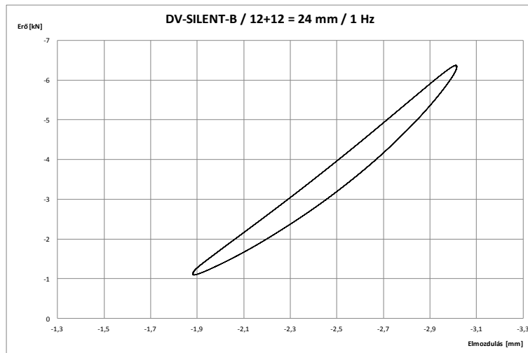
71. ábra: A DV-SILENT-B típusú gumilemez dinamikus rugalmasság-vizsgálata során felvett erő-elmozdulás diagramok (12 + 12 = 24 mm vastagság esetén, 1 Hz terhelési frekvencián)
