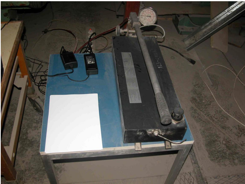
8. kép: A statikus mérések során a terhelő erő kifejtésére használt hidraulikus sajtó
