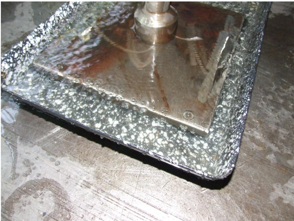
3. kép: Terhelés közben a pórusok közül kiszorult levegő buborékok formájában jelennek meg a vízen
