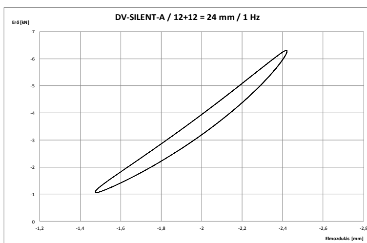
43. ábra: A DV-SILENT-A típusú gumilemez dinamikus rugalmasság-vizsgálata során felvett erő-elmozdulás diagramok (12 + 12 = 24 mm vastagság esetén, 1 Hz terhelési frekvencián)
