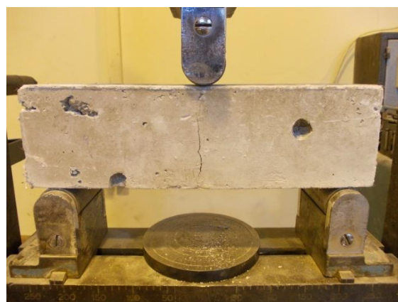
31. ábra - Pórusbeton adalékanyagoss próbatess tönkremenetele
