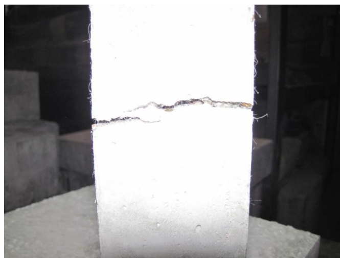
44. ábra - Repedést áthidaló PP szálak
