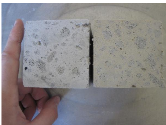
26. ábra - Nyomószilárdsági vizsgálathoz készített próbatestek 27. ábra - Tönkrement nyomószilárdsági próbatest
