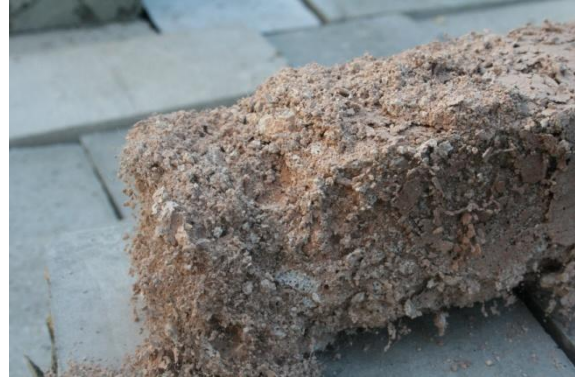
33. ábra - 25 fagycikluson átesett próbatest
