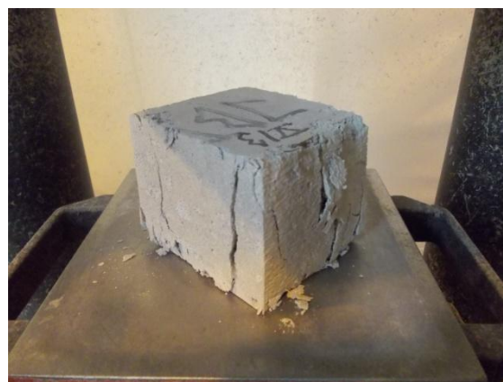
26. ábra - Nyomószilárdsági vizsgálathoz készített próbatestek 27. ábra - Tönkrement nyomószilárdsági próbatest
