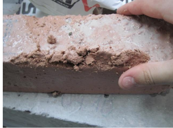
39. ábra - Kézzel morzsolható próbatest
