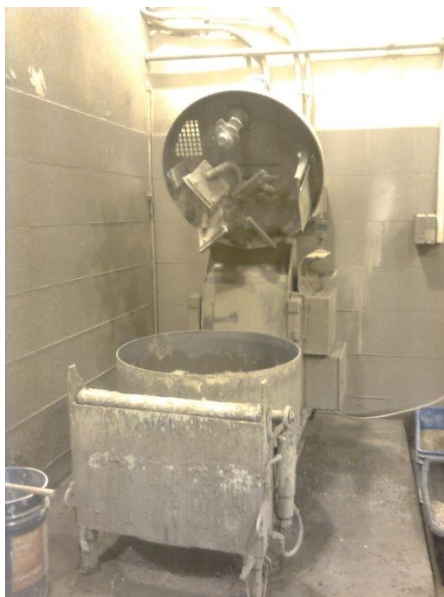
24. ábra – Zyklos típusú kényszerkeverő
