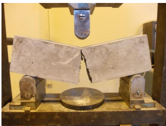
30. ábra - Kavicsbeton próbatess tönkremenetele
