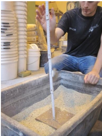
28. ábra - Ütésállósági vizsgálat
