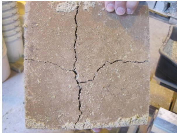
29. ábra - Tönkrement ütésállósági próbatest
