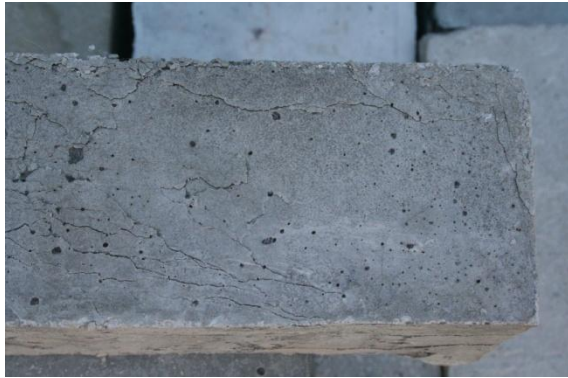
32. ábra - 10 fagycikluson átesett próbatest
