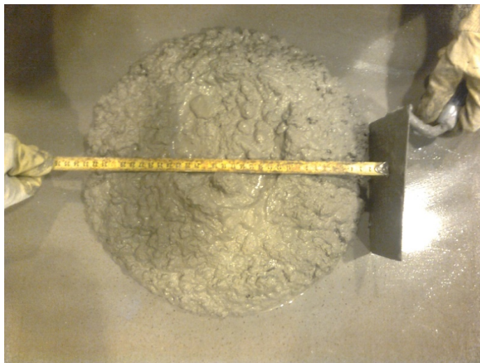
5.9. ábra – Területi átmérő mérése
