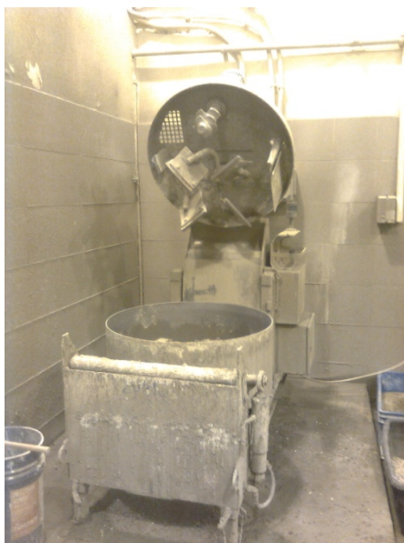
5.10. ábra – Zyklos típusú kényszer keverőben
