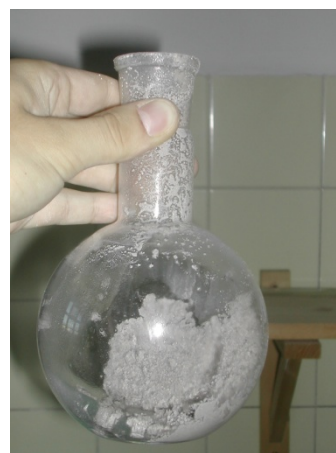
5.5.- 5.6. ábra - Adalékanyag vízfelvételének vizsgálata piknométerrel
