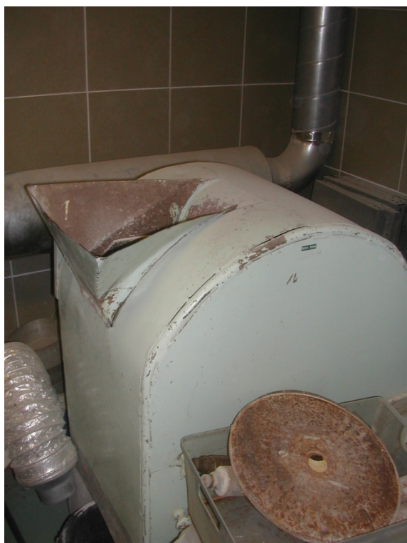
5.2. ábra - Pofás törőgép
