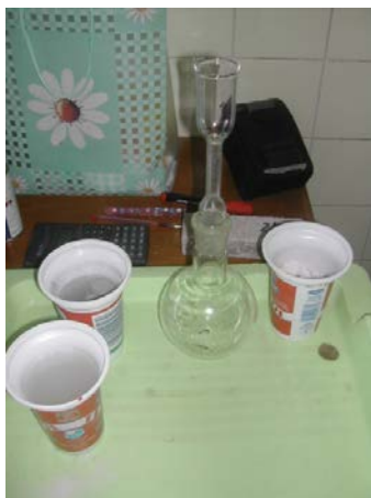
5.5.- 5.6. ábra - Adalékanyag vízfelvételének vizsgálata piknométerrel
