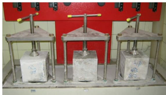
5.22. ábra – Vizsgálópadra szorított próbatestek
