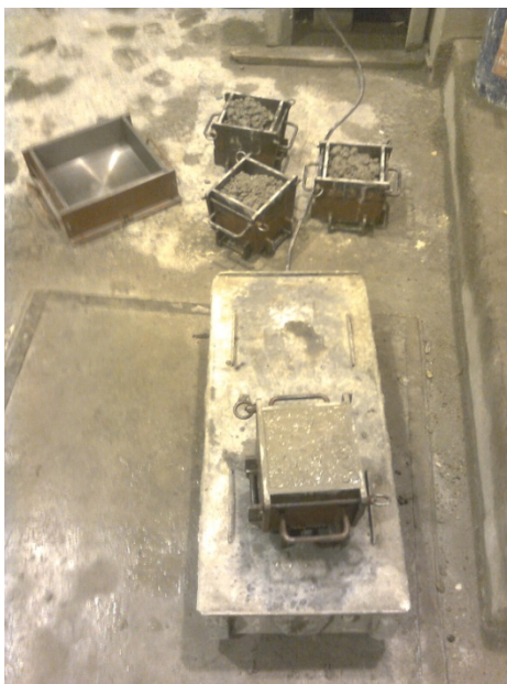
5.12. ábra – Rázóasztal a próbatestek bedolgozása közben
