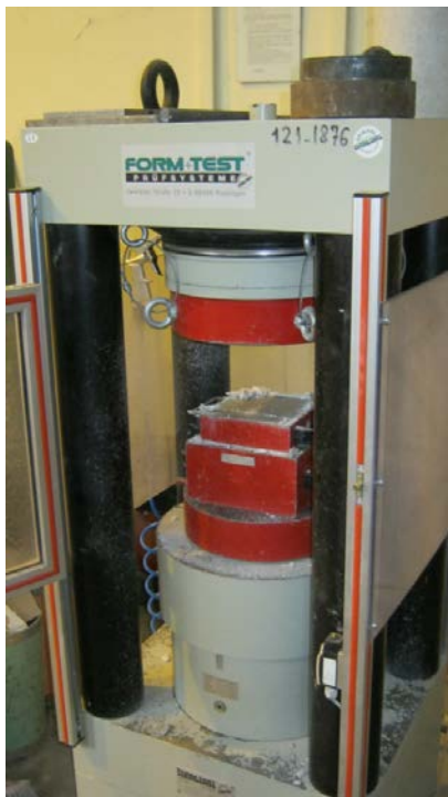
5.19. ábra Formtest típusú törőgép
