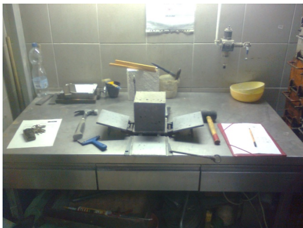
5.15. ábra – Próbatest kiszaluzása
