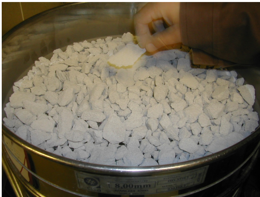
4.2. ábra – Zúzott pórusbeton adalékanyag
