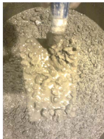
5.13. ábra – Megfelelő konzisztencia 5.14. ábra – Adalékanyag szemek felúszása és kivézés
