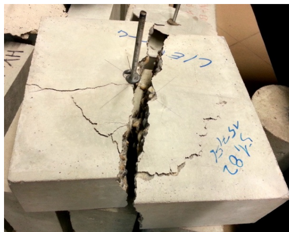
3.13 b. ábra – Póbatest felhasadása
