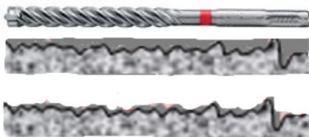
3.17. ábra – Ütvefúró által létrejött furatfelület metszete tisztítás nélkül és kitisztítva
