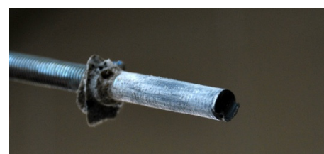
3.5. ábra – Ragasztó elnyíródás
