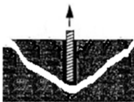
3.8 a. ábra – Teljes szakadókúp [4]
