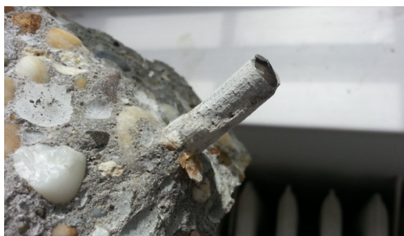
3.9 b. ábra – Kombinált tönkremenetel
