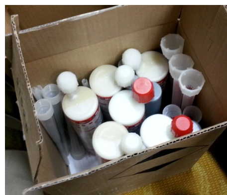
4.2. ábra – Ragasztók és a hozzájuk tartozó keverőszárok
