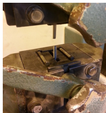
8.6. ábra – Mentés szár szakító vizsgálat
