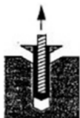
3.9 a. ábra – Kombinált tönkremenetel [4]
