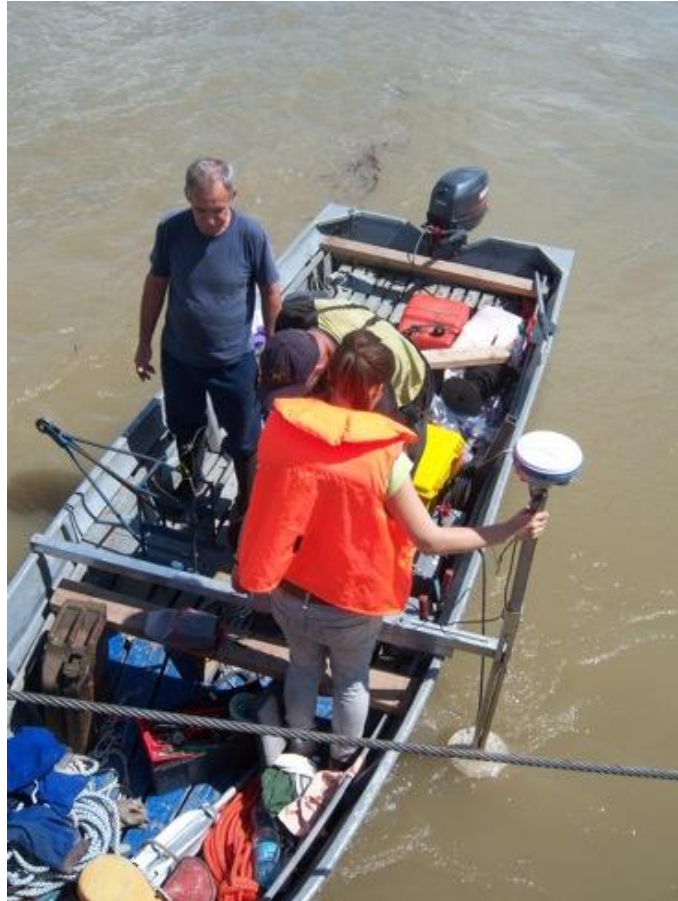
17. ábra: csónak valamint az oldalához rögzített ADCP műszer
