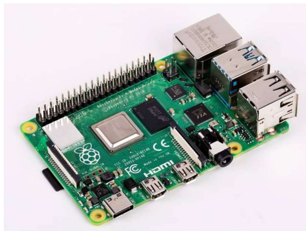
6. ábra Egy Raspberry Pi 4 model B ( https://malnapc.hu/ )
