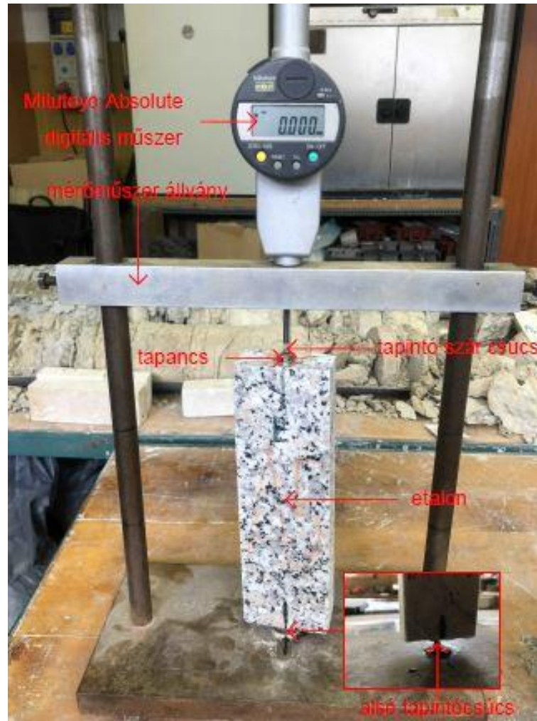
12. kép: Mitutoyo Absolute digitális műszer állvánnyal és a kijelölt etalonnal
