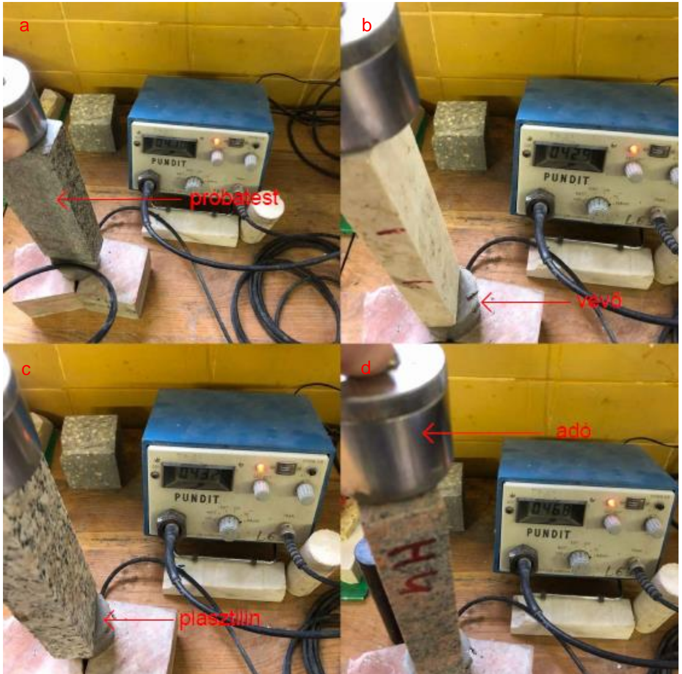
11. kép: Ultrahanghullám terjedési sebessége a minták magasságának függvényében és a Pundit ultrahang terjedési sebesség mérő berendezés (a – gneisz, b – forrásvízi mészkő, c – rozabeta gránit, d – brazil gránit)
