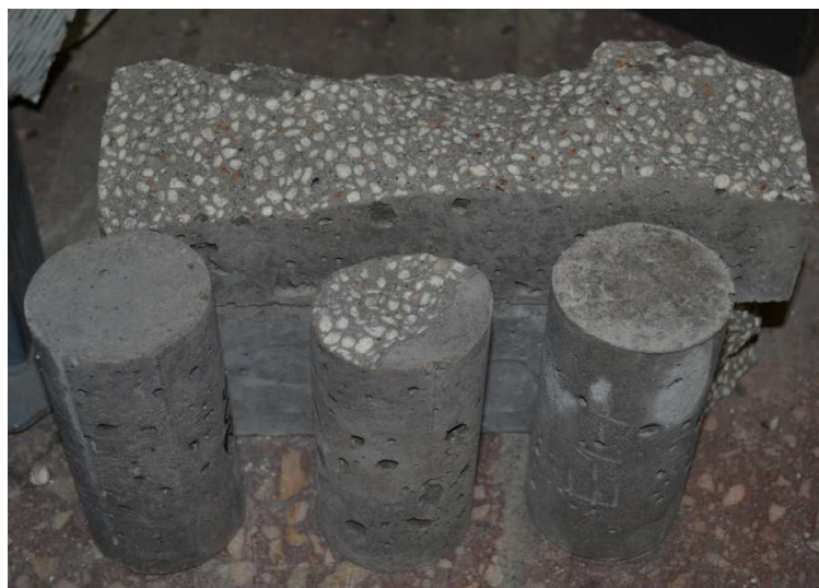
4-25. ábra 500 °C-nak kitett próbatestek
