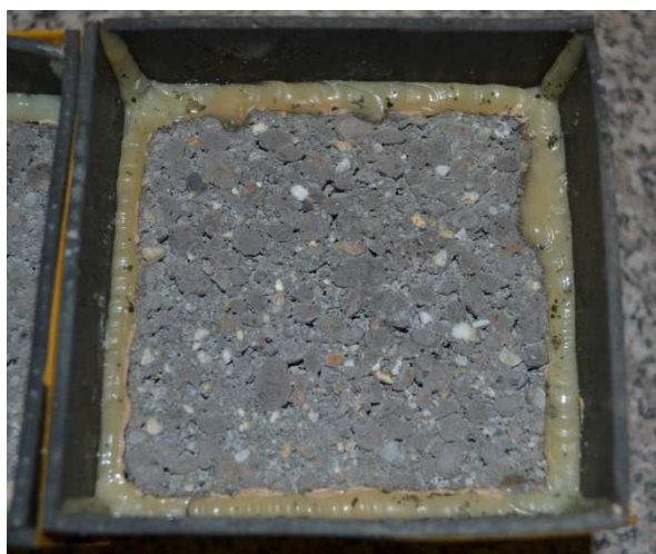
4-48. ábra Péptelítetlen próbatest
