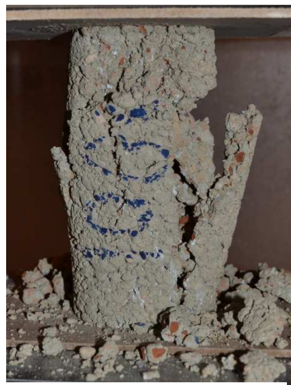
4-14. ábra Henger töréskép V.
