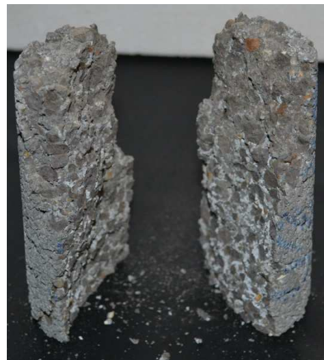
4-12. ábra Henger töréskép III.
