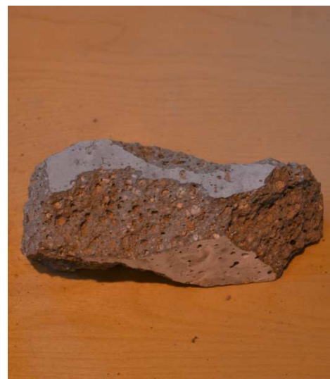
4-26. ábra 800 °C-nak kitett hasáb
