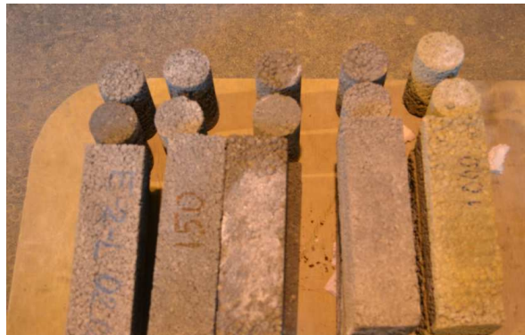
4-9. ábra Duzzasztott agyagkavics adalékanyagú próbatestek hőterhelés után
