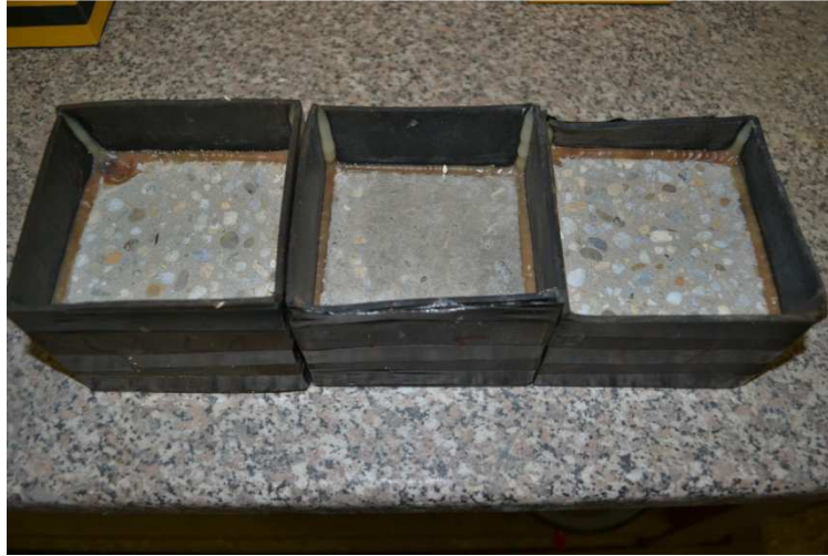
4-41. ábra Kvarckavics adalékanyagos fagyhámlasztási próbatestek
