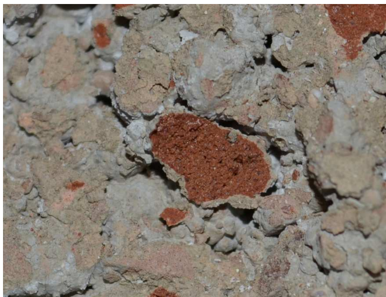
4-15. ábra Kiégett duzzasztott agyagkavics szemcse
