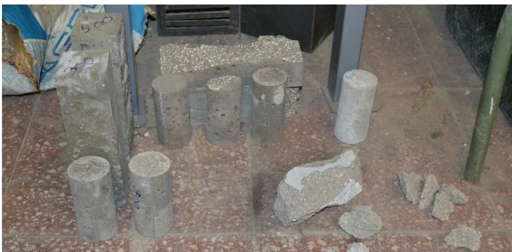
4-24. ábra Duzzasztott üvegvadics adalékanyagú próbatestek hőterhelés után
