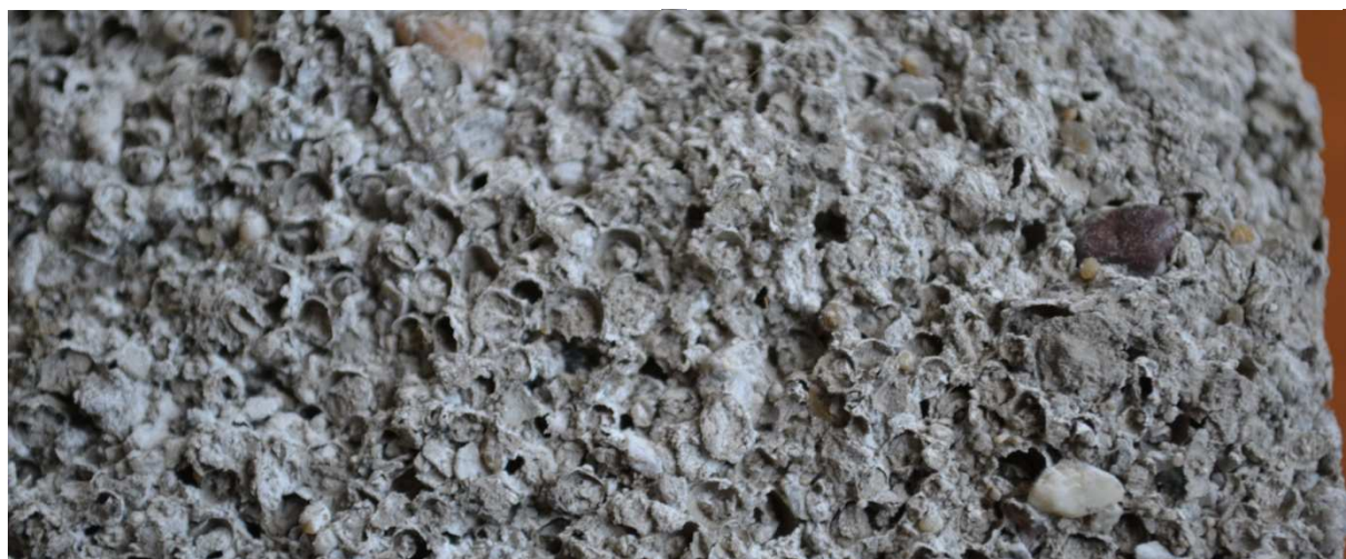
4-37. ábra Kiégett polisztirol gyöngy adalékanyagú próbatest pórusképe
