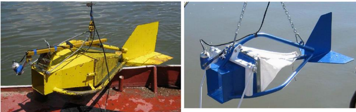
1. ÁBRA A KAVICS (BAL - „KIS” KÁROLYI-FÉLE) ÉS HOMOK FRAKCIÓJÚ (JOBBA - HELLEY-SMITH) MEDERSZAKASZOKON HASZNÁLT GÖRGETETT HORDALÉK MINTAVEVŐK
