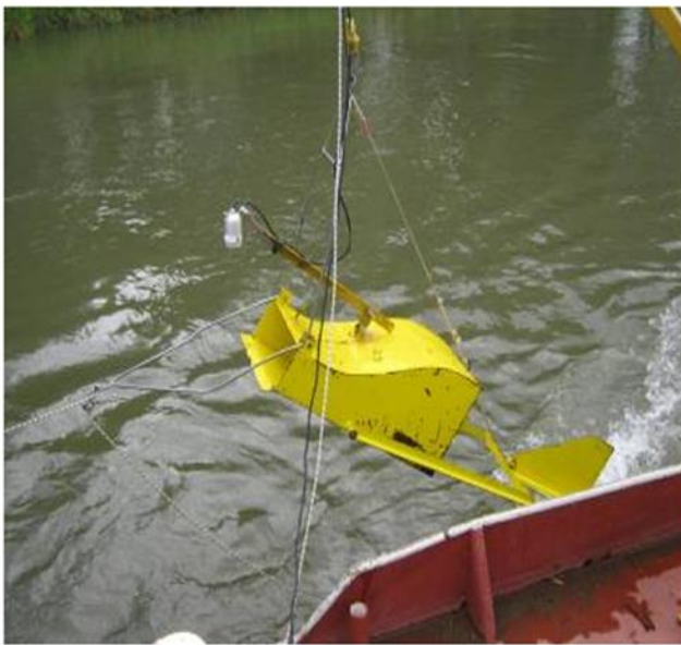
2. ÁBRA A KAVICSMEDRŰ FOLYÓSZAKASZOKON HASZNÁLT KÁROLYI - FÉLE GÖRGETETT HORDALÉK MINTAVEVŐ
