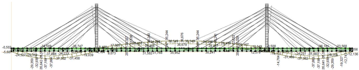
50. ábra: A saját modell lehajlásai 2. teherállás esetén
