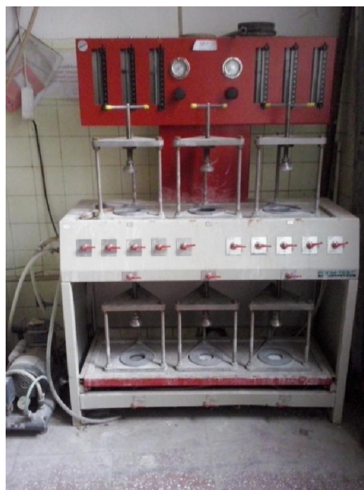
3.1.6. ábra: Vízárósági vizsgálatához alkalmazott berendezés
