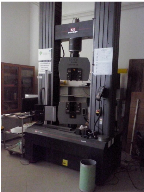
3.1.5. ábra: Hajlítás vizsgálathoz alkalmazott berendezés
