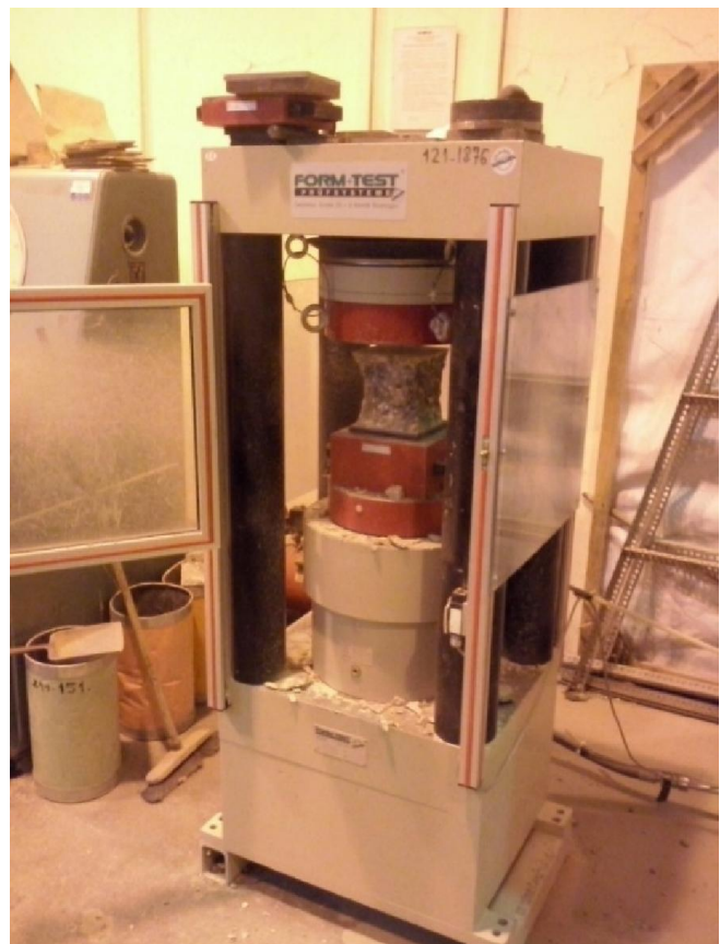
3.1.3. ábra: Nyomószilárdság vizsgálatához használt eszköz
