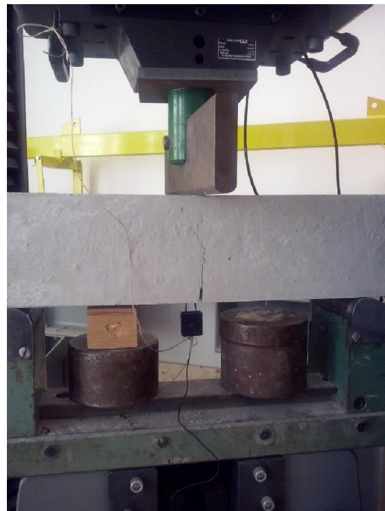
3.1.5. ábra: Hajlítás vizsgálathoz alkalmazott berendezés
