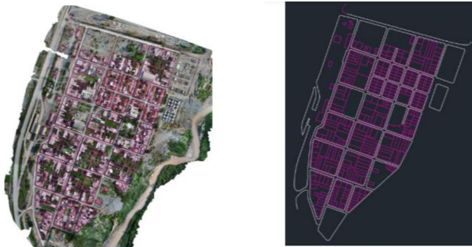
11. ábra: Az ortofotó és a levezetett ingatlan-nyilvántartási térkép (Gutiérrez et al. 2019)
