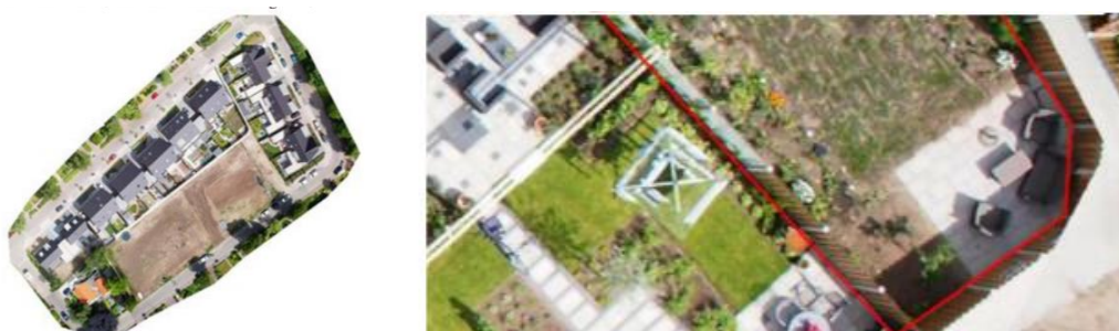
2. ábra: Az előállított ortofotó és a kiértékelt telekhatár ( Rijsdijk et al. 2013 )
