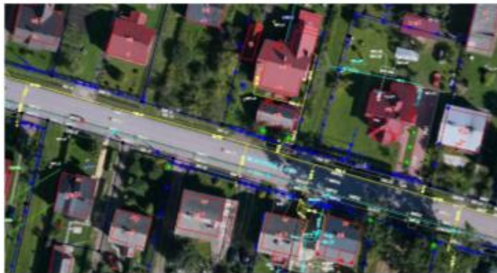
7. ábra: UAV ortofotó alapján felújított alaptérkép (Kedzieriski et al. 2016)
