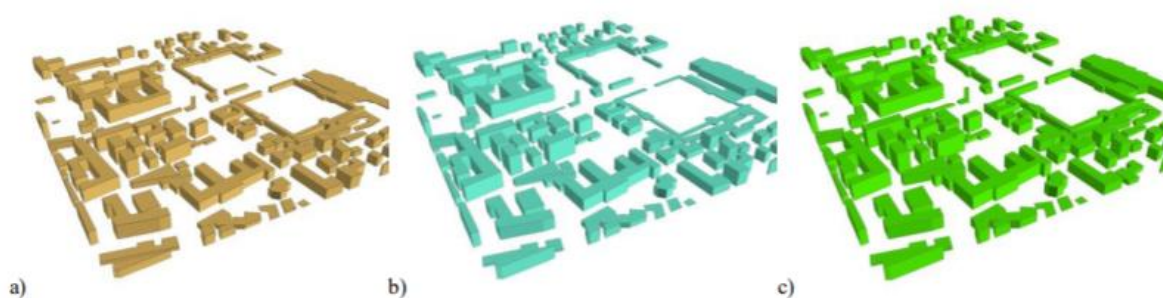
3. ábra: Az 1:10 000-es topográfia térképből generált LoD1-es épület modellek (a: GeoEye; b: légifotó; c: Lidar) ( Moreira et al. 2013 )
