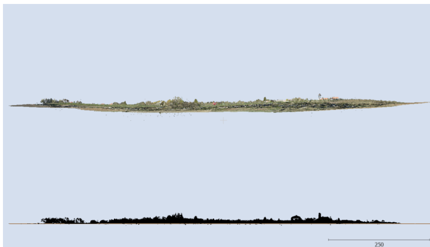
31. ábra: Az eredeti pontfelhő és a normalizált pontfelhő
