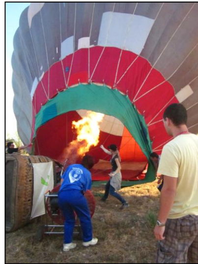
34. ábra. A ballonozás elengedhetetlen művelete, a kupola fűtése (forrás: saját felvétel)
