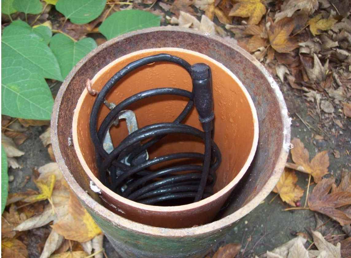
3. kép A folyadékszint rögzítő berendezés a GWM-31-es kútban
