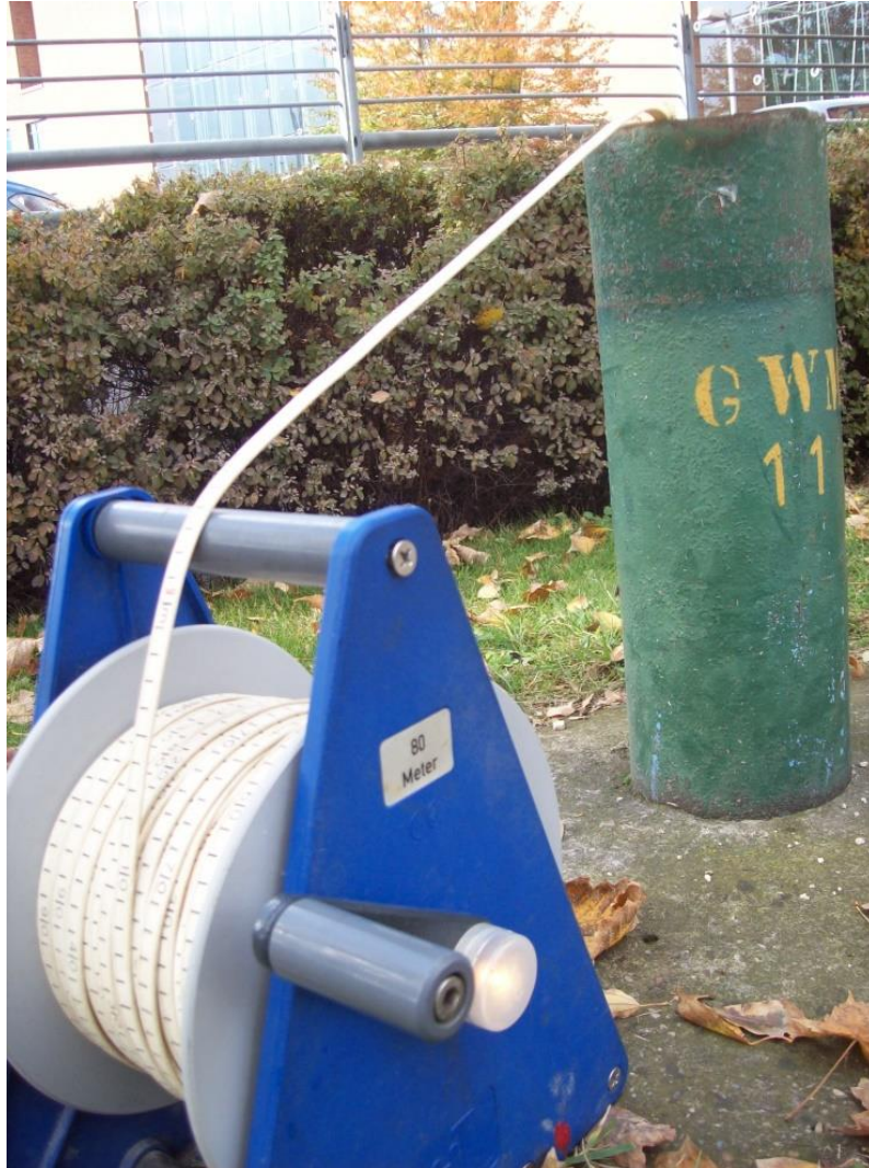
2. kép A fényjelzős talajvízszintmérő műszer
