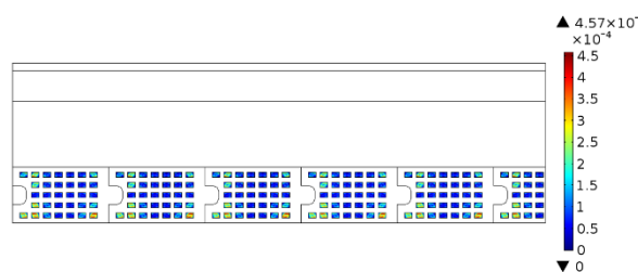
78. ÁBRA: ÚJLAKI FÖDÉM HOSSZMETSZET, SEBESSÉG TÉR [ms -1 ]
