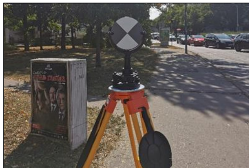
13. Ábra Leica HDS 6" tárcsa az egyik állásponton
