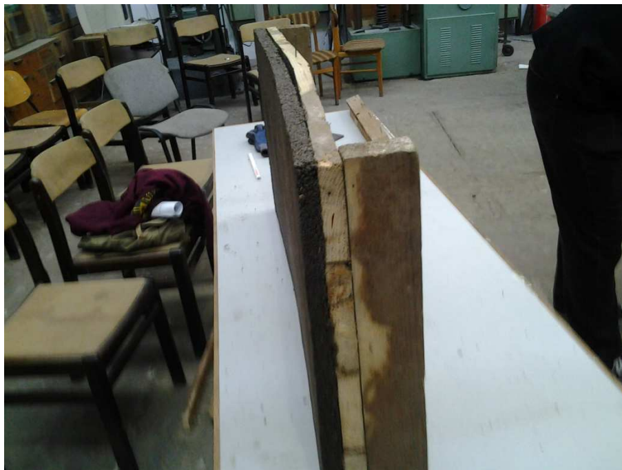
22. ábra Az anyag a nyírás miatt elvált a deszkázattól, majd a deszkázat tönkremenetele után épségben maradt
