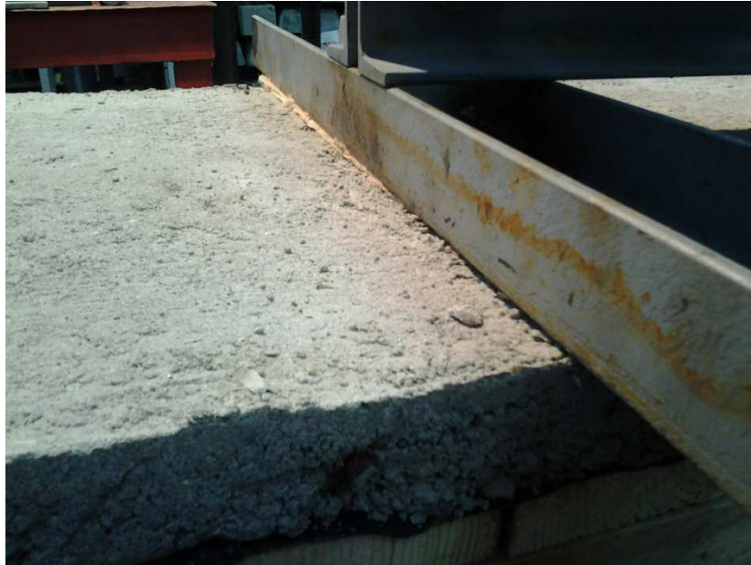
18. ábra A nyomott öv a terhelés végeztével
