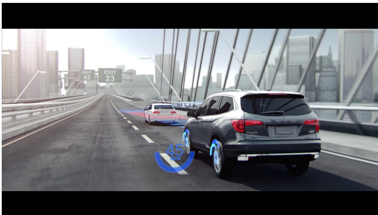
4. kép Adaptív tempomat működése érzékelési távolságon belüli járművel [14]
