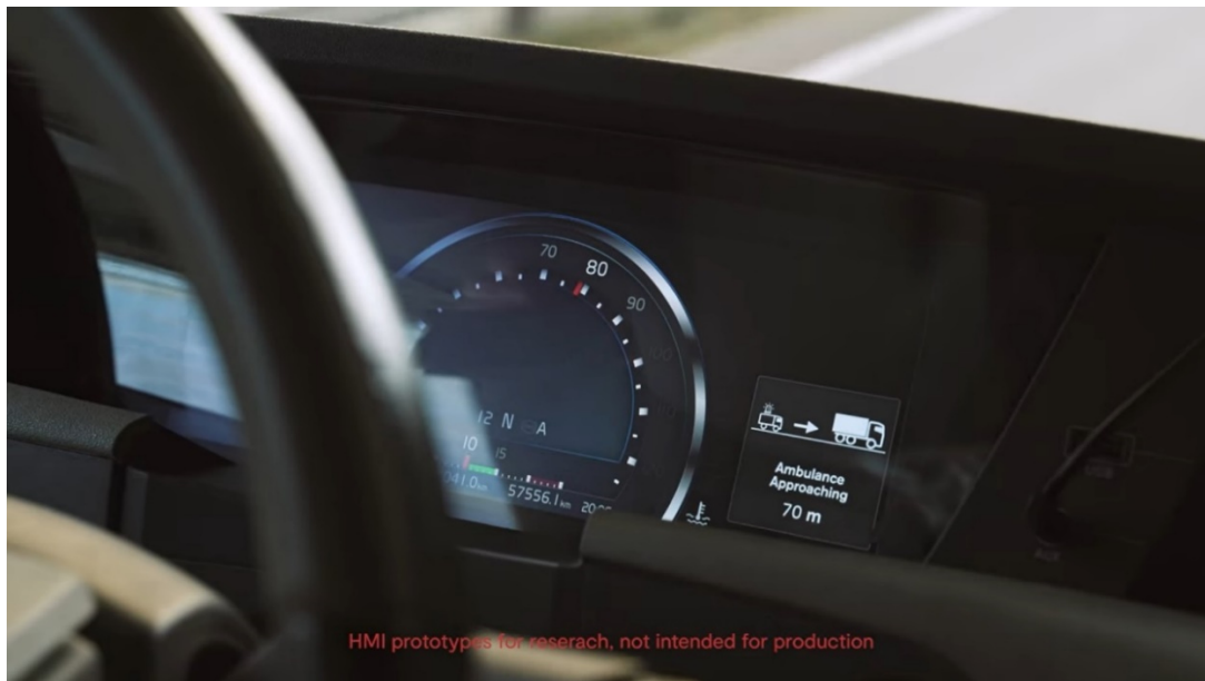
5. kép Műszerfalon megjelenő figyelmeztetés megkülönböztető jelzést használó járműre [15]
