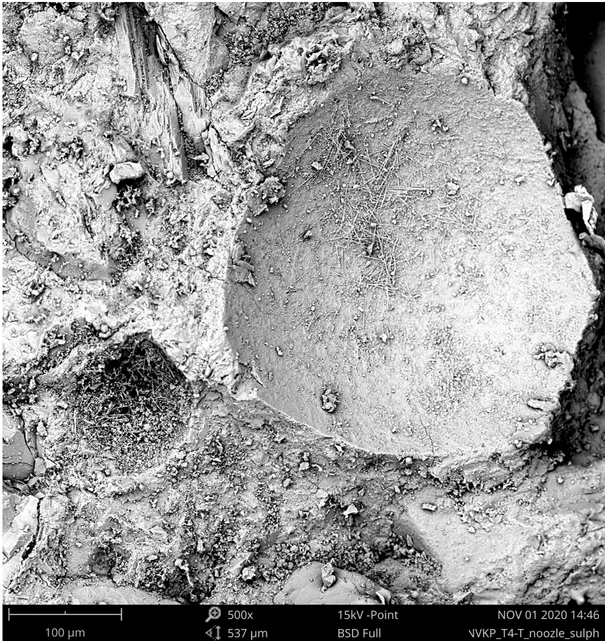
19. kép: A T4/T betonminta a savsugaras (fűvókás) gépi kezelést követően, elsősorban ettringit tűkristályok a pórusok belső felületén
