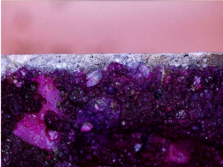
5. kép: Evetsavas forgó savgéppel kezelt Támfal termék próbatest fenolftaleinnel festett törési felülete (saját felvétel)
