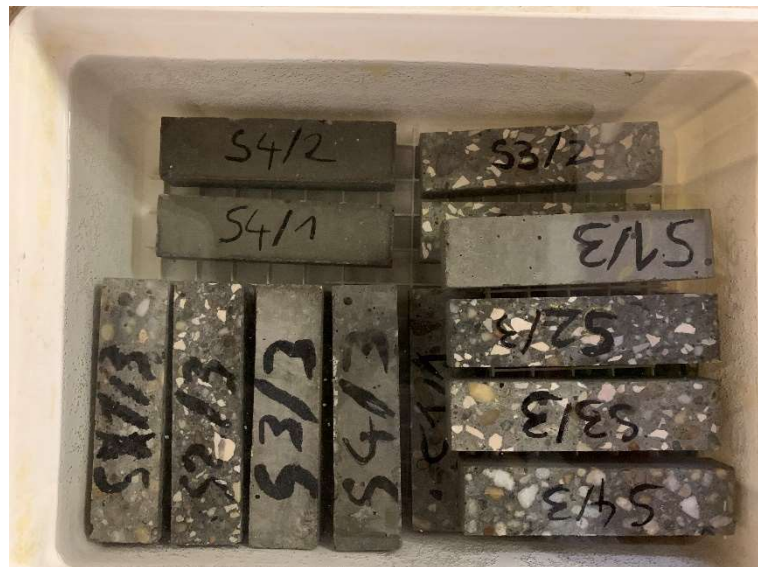
1. kép: Az S jelölésű betonok statikus kénsavas vizsgálatuk elején (saját kép)
