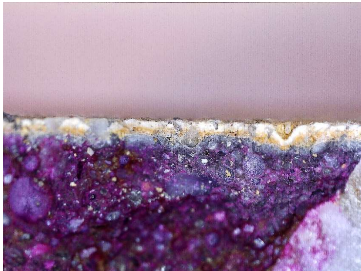
8. kép: Kénsavas folyadéksugaras savgéppel kezelt Támfal termék próbatest fenolftaleinnel festett törési felülete (saját felvétel)
