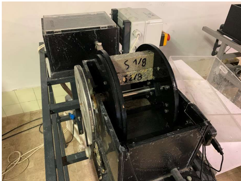
2. kép: A forgó rendszerű savkorróziós vizsgálati készülék (saját kép)
