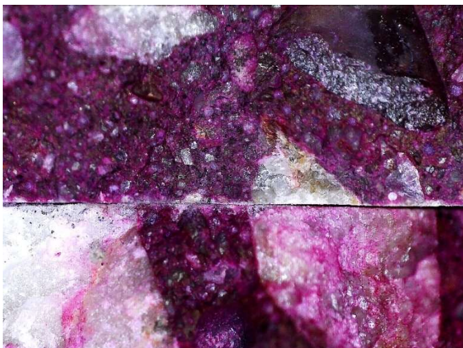
9. kép: Felül: kénsavval statikusan kezelt Támfal termék próbatest fenolftaleinnel festett törési felülete, alul: vízben tárolt próbatest fenolftaleinnel festett törési felülete (saját felvétel)
