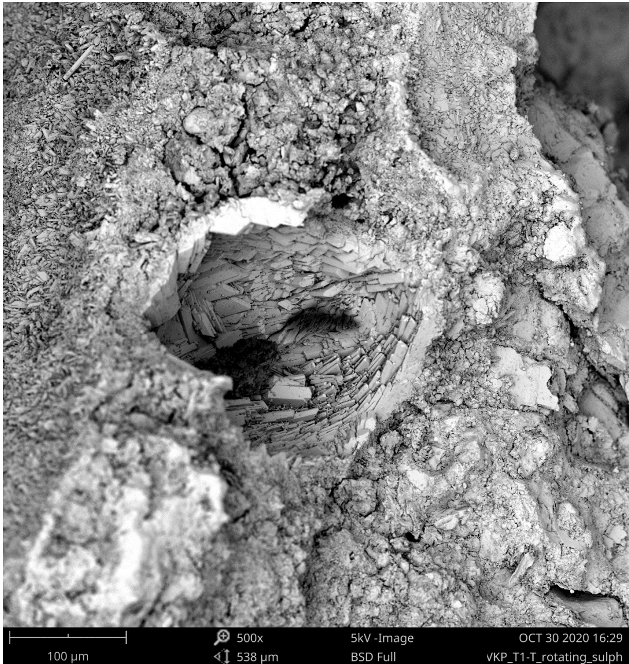
14. kép: A T1/T betonminta SEM felvétele, kénsavas forgógépes kezelést követően: a kezelés hatására gipszkristályok keletkeztek a kezelt felülethez közeli pórusokban
