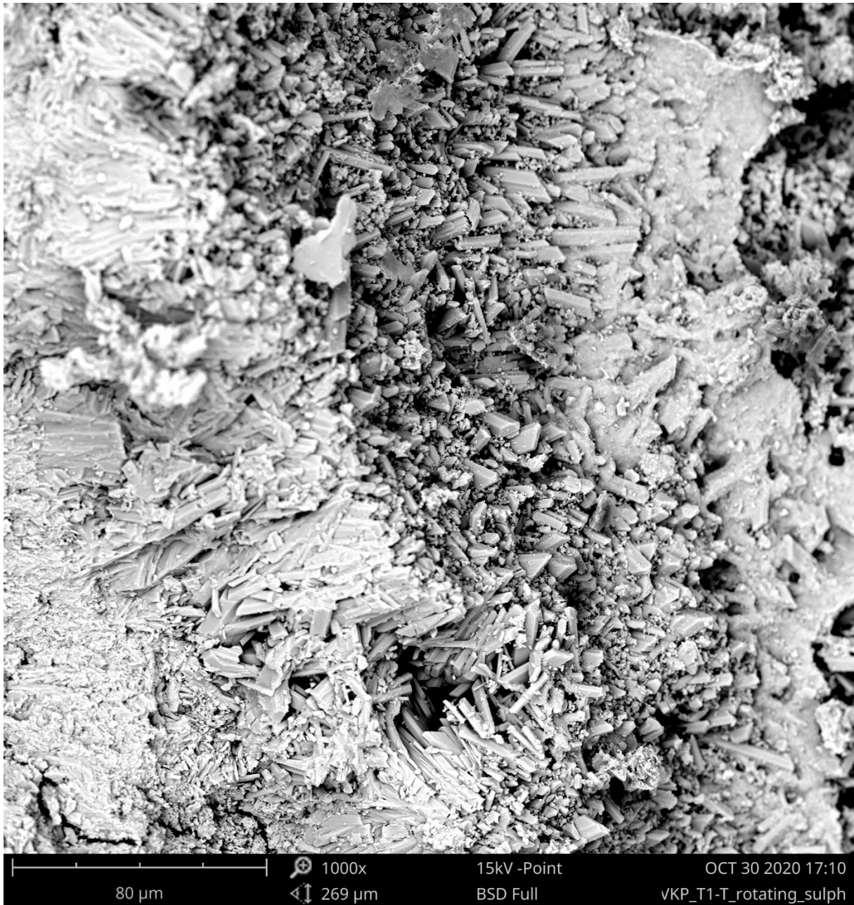
15. kép: A T1/T betonminta SEM felvétele, kénsavas forgógépes kezelést követően, a kezelt felületről néhány mm mélységben: az apró gipsz kristályokkal tömött szövetszerkezet
