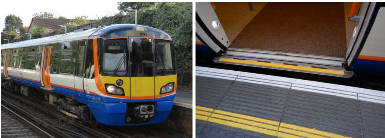
51. ábra. Class 378-as szerelvény kinyúló rámpákkal [14] (balra); A jármű kinyúló rámpája magasperon mellett [3] (jobbra)
