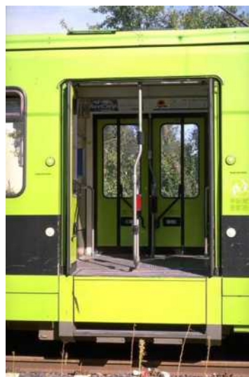
54. ábra. A TW6000-res villamos ajtaja lenyíló lépcsővel, és lenyíló lépcső nélkül. [5]
