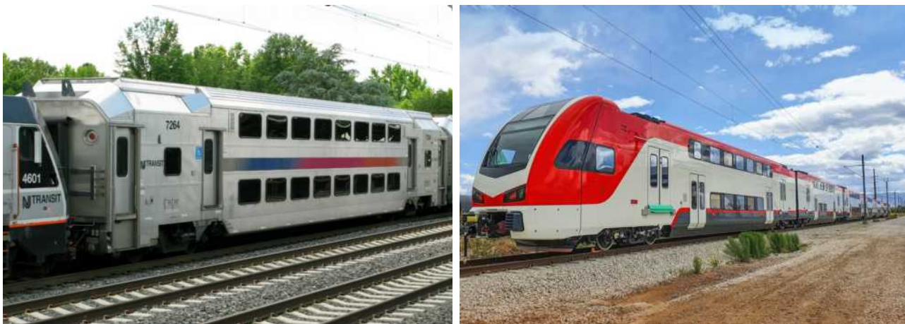
50. ábra. A Bombardier eltérő peronmagassághoz igazodó speciális járműve [36] (balra); A Stadler két peronmagasságra nyíló KISS motorvonata [44] (jobbra)
