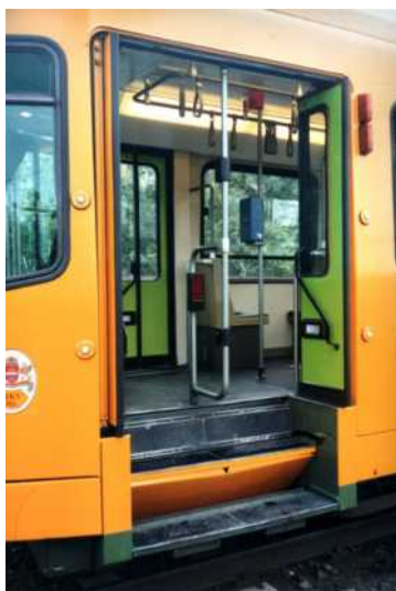
54. ábra. A TW6000-res villamos ajtaja lenyíló lépcsővel, és lenyíló lépcső nélkül. [5]
