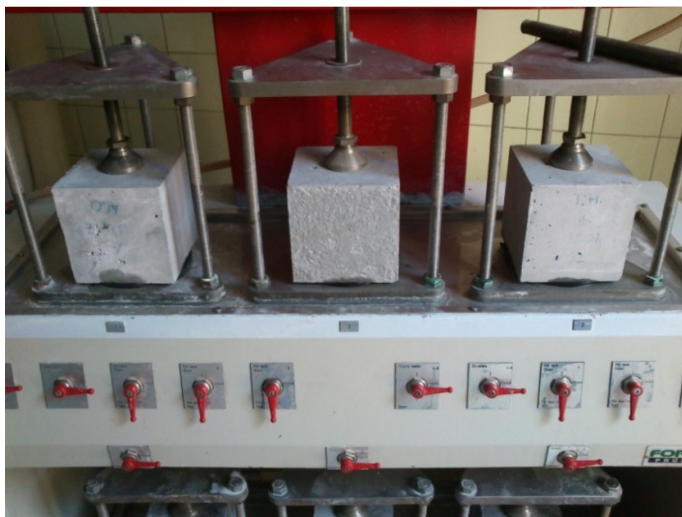
3-13. ábra: Vízjáróság vizsgálat az MSZ EN 12390-8:2009 szerint
