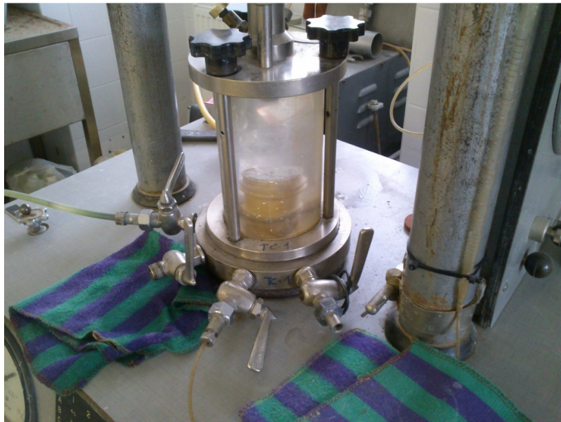
3-18. ábra: Vízáteresztő-képesség mérése triaxiális berendezéssel
