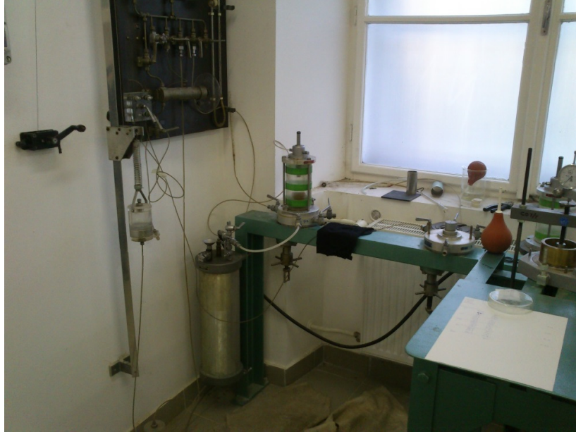
3-17. ábra: Átalakított triaxiális mérőberendezés
