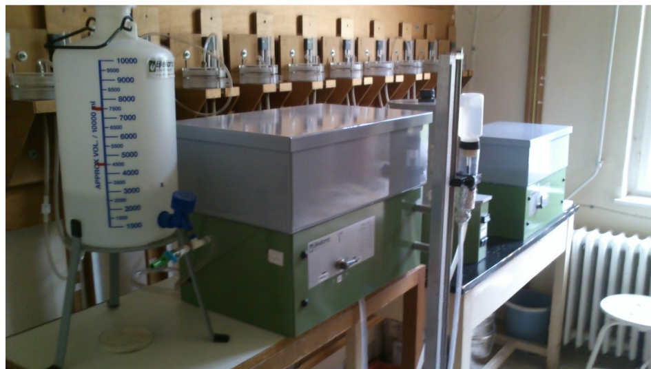
3-19. ábra: Víztartási görbe meghatározása gravitációs módszerrel
