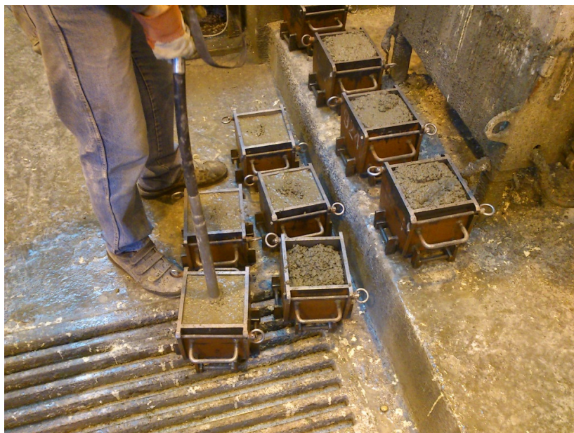
3-9. ábra: Beton tömörítése
