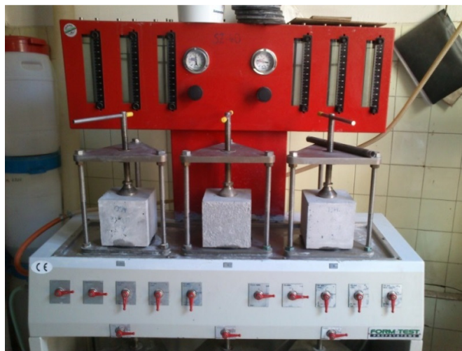
2-24. ábra: A vízzáróság vizsgálat MSZ-EN 12390-8:2009 szerinti elrendezése
