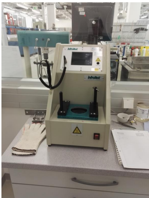
6. ábra Lágyuláspont meghatározása MSZ EN 1427
