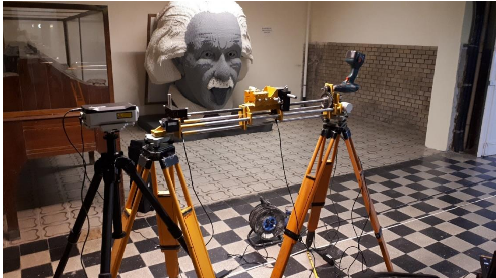
14. ábra: Lineáris vezető és az interferométer összeállítva
