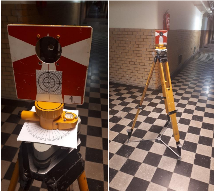
15. ábra: A fólia forgatásához használt szögmérő, és állvány.
