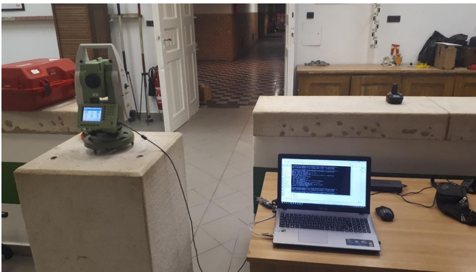
13. ábra: Mérőállomás pilléren, számítógépről vezérelve
