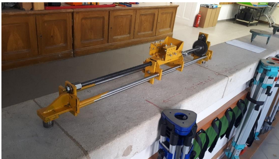
10. ábra: A fólia mozgatásához használt lineáris vezető.
