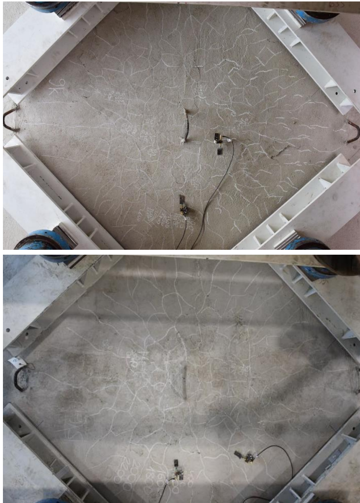
48. ábra: Felül a 9./k, alul a 9./s próbatestek repedésképe, és a repedéstágasság mérők elhelyezkedése
