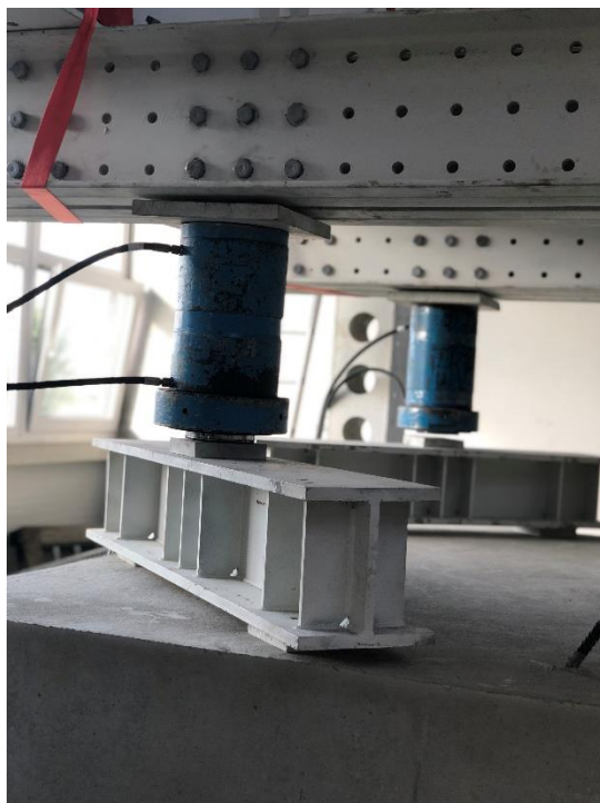
26. ábra: Hidraulikus sajtoló erő kifejtése a teherelosztó gerendákra
