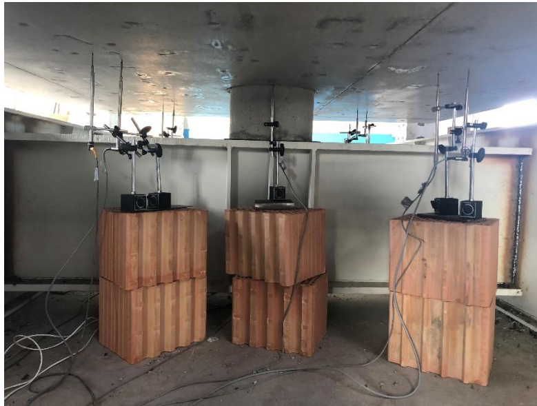
28. ábra: Induktív adók elhelyezkedése a próbatestek alsó síkján
