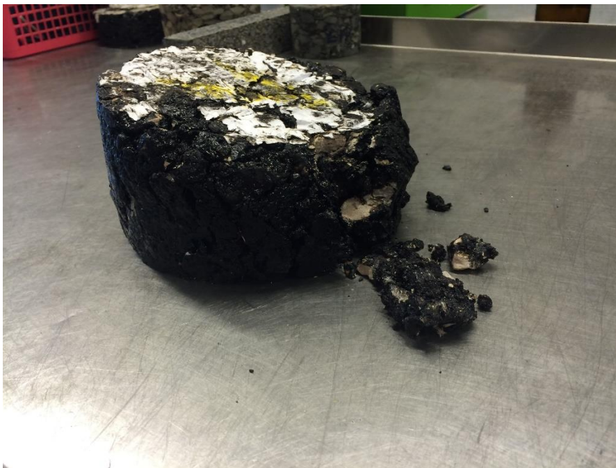
27. ábra: Tönkrement próbatest triaxiális vizsgálat után (4%)
