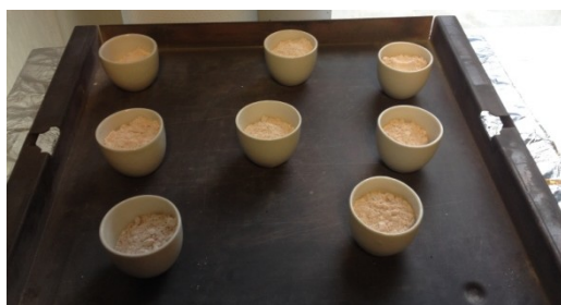
9. ábra: Mészköliszt égetése csészékben
