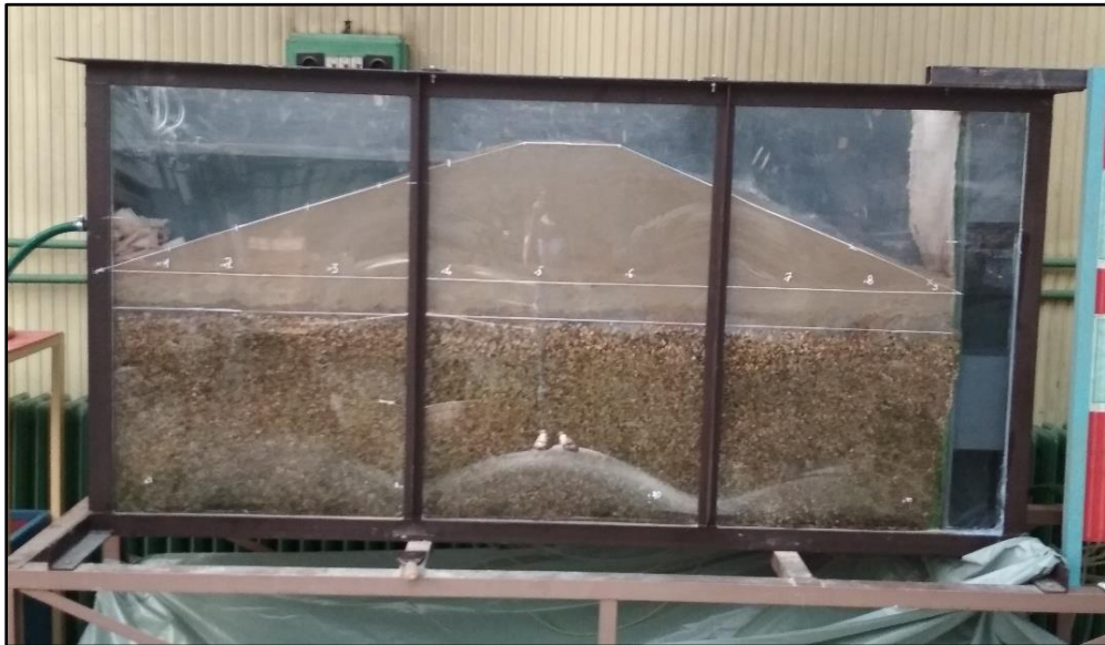
3. ábra Az vízzáró réteggel határolt gát
