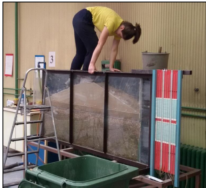
7. ábra A gát építésekor az anyagok tömörítésére volt szükség
