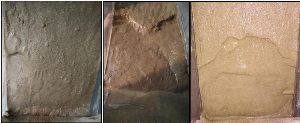
21. ábra Bal: Az első észrevett tönkremenetel. Közvetlenül vízzáró rétegen álló töltés mentettoldali megfolyása. Középső: A második kialakításon az első feltöltéskor bekövetkezett a megfolyás. Először V alakban, majd fél nap alatt az alakja kiegyenesedett. Jobb: Megpróbáltam helyreállítani, de a végeredmény hasonló lett.
