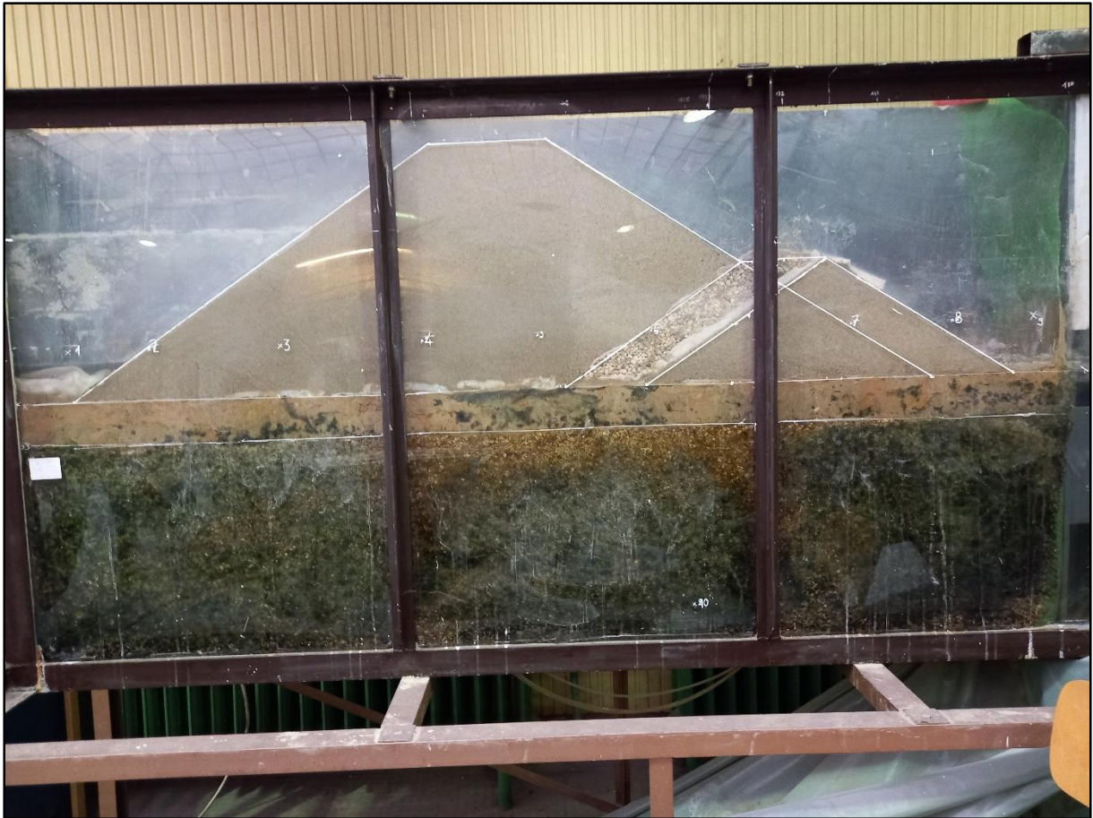
10. Kép: Töltés megtámasztással, közbenső kavicsréteggel
