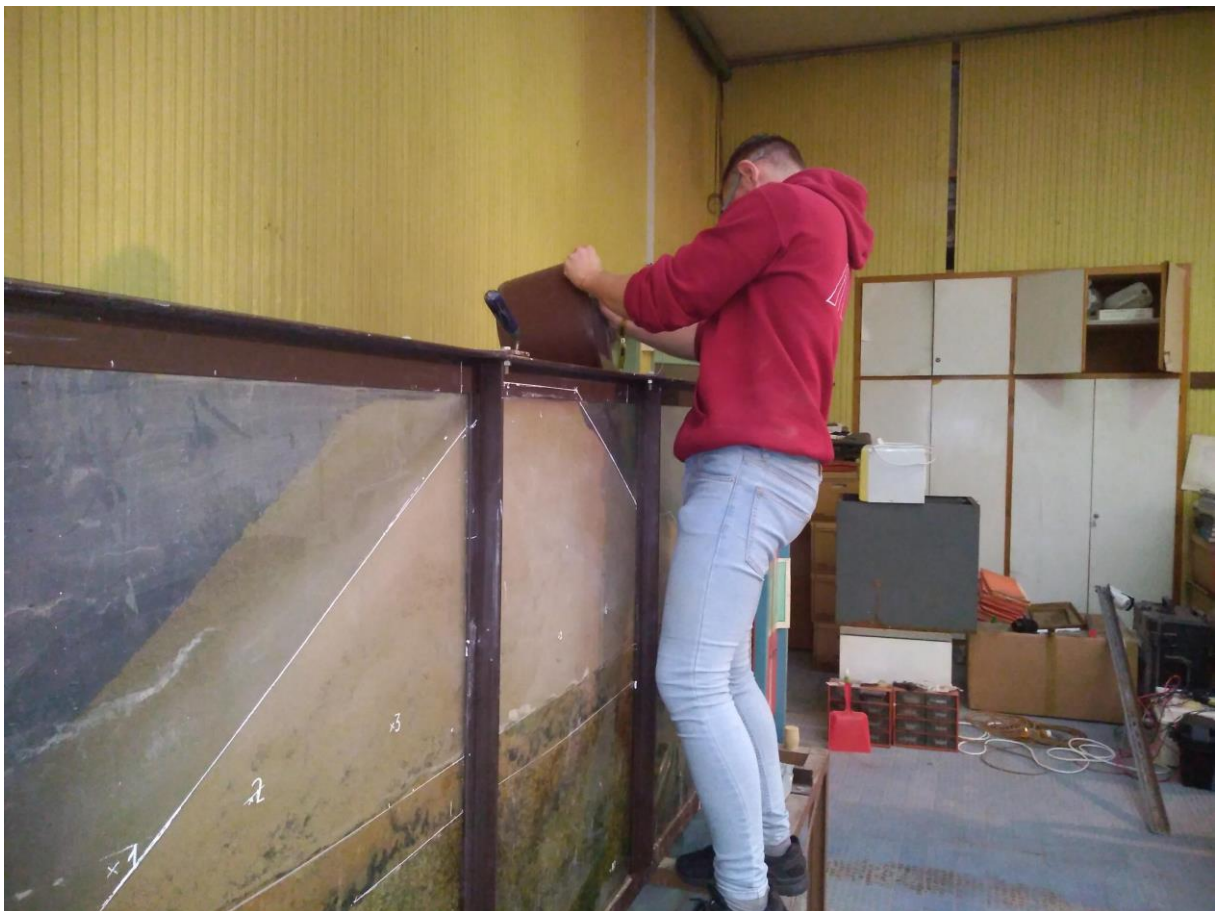
4. Kép: Homokos iszap töltés megtámasztással, építés közben
