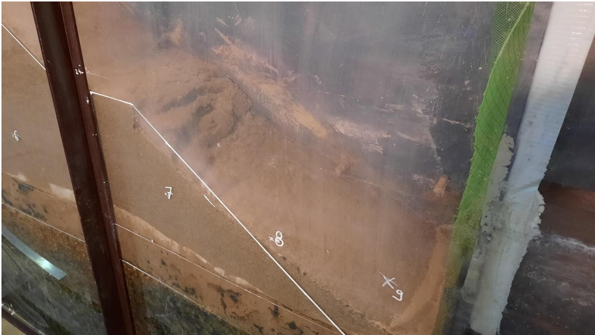
6. Kép: A megtámasztás megcsúszása a mentett oldalon
