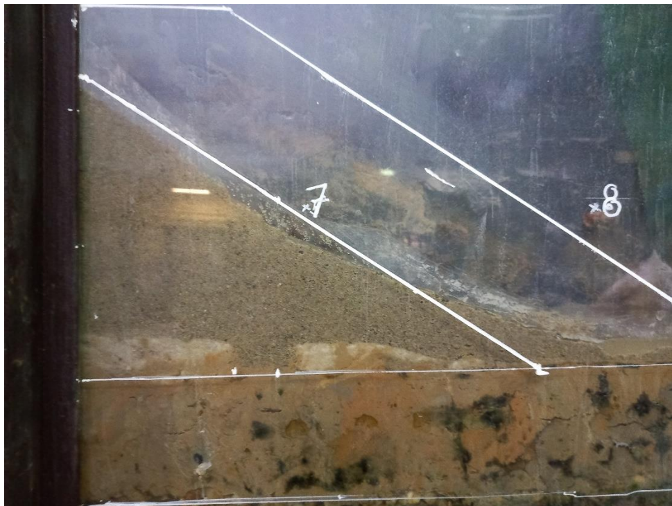
9. Kép: A mentett oldali részű alsó szakaszának megcsúszsása
