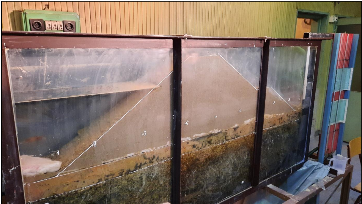
5. Kép: Homokos kavics töltésszelvény megtámasztással, víz ráeresztése után
