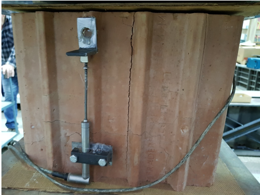
12. ábra: Függőleges repedés
