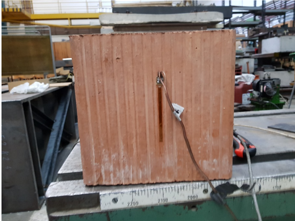
7. ábra: Függőlegesen elhelyezett nyúlásmérő bélyeg
