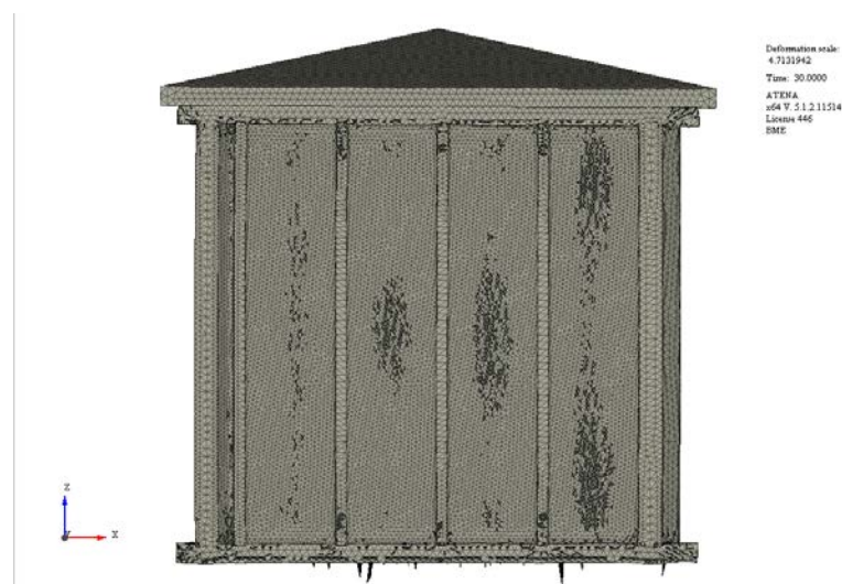
66. ábra: A 2. modell végső deformációja, repedéseképe a belső oldalon
