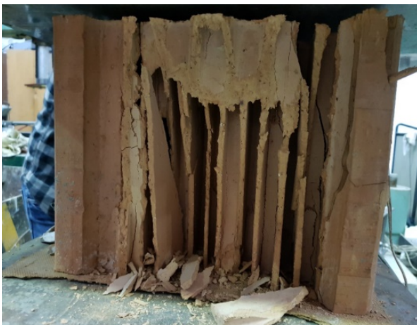
1. ábra: Laboratóriumi kísérlet (tönkrement falazóelem)
