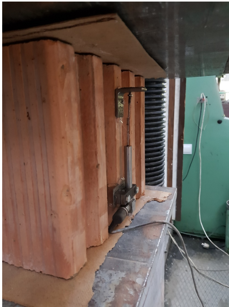
6. ábra: Induktív elmozdulásmérő
