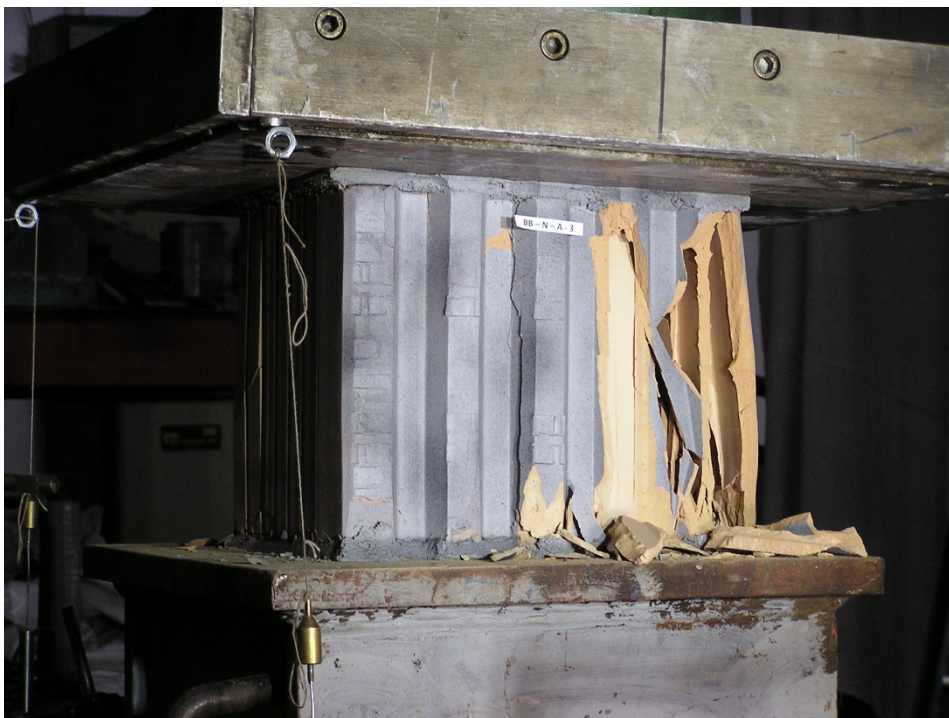
55. ábra: A belső szerkezet tönkremenetele
