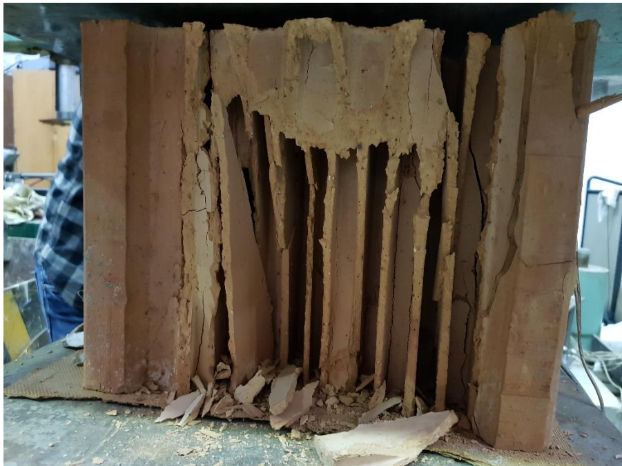
13. ábra: A tönkrement falazóelem
