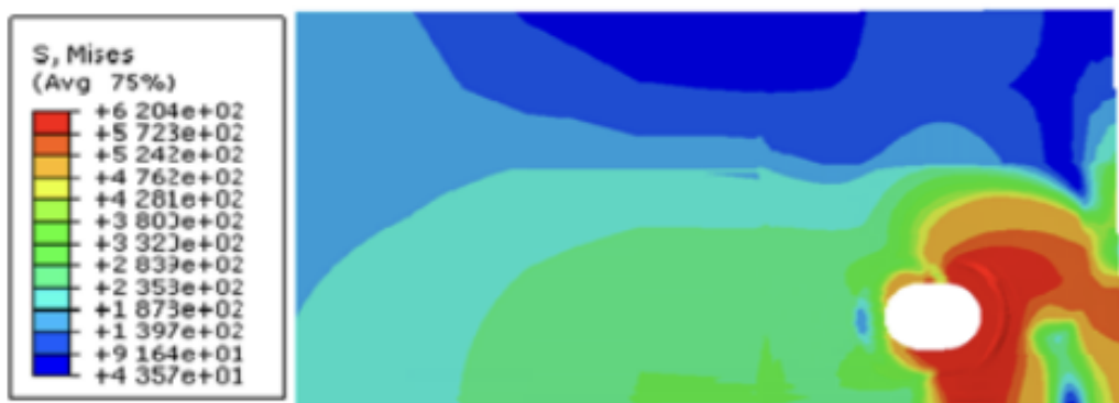
13. ábra – Lemez végelem modellje, feszültségeloszlása és deformált alakja [9]
