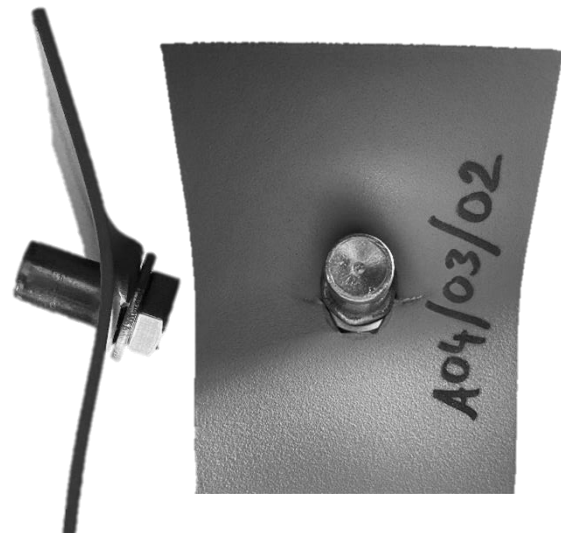
17. ábra – Próbatest terhelés utáni deformált alakja
