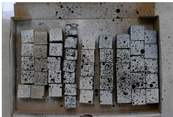
3.3. ábra: DIC méréshez előkészített próbatestek
