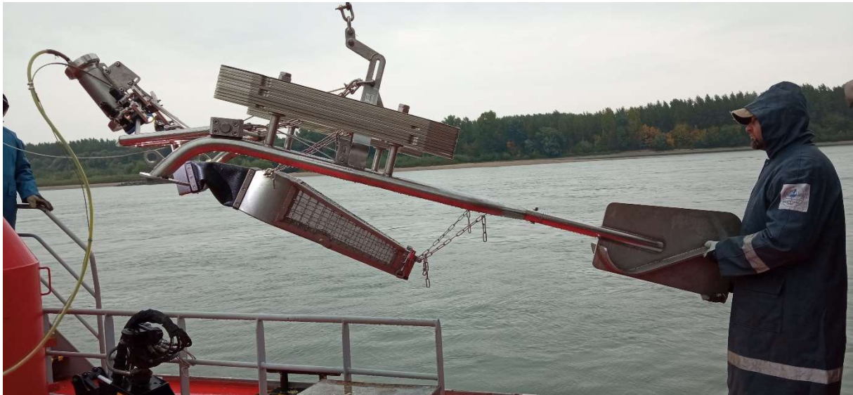
5. ábra BfG görgetett hordalékmintavevő műszer
