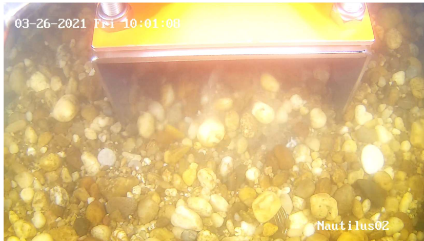
10. ábra Lehelyezéskor a mérőműszer belemarkol "belekap" a meder anyagába
