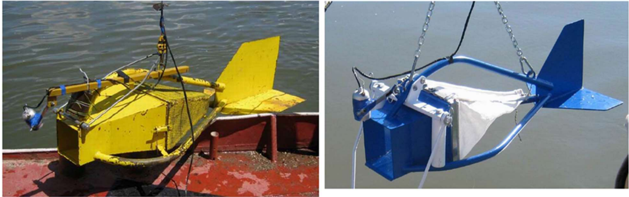
2. ábra A kavics (bal – „kis” Károlyi-féle) és homok frakciójú (Jobb – Helley-Smith) mederszakaszokon használt görgetett hordalék mintavevők (Szombati, 2014).
