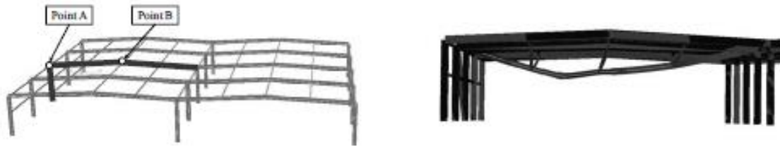
17. ábra: A teljes modellen a tűz és a deformált alak nézete (Forrás:[4])
