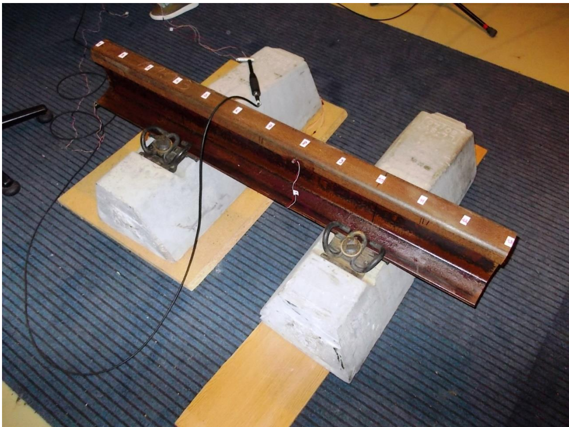
2. kép Laboratóriumban összeállított mérési rendszer (balról jobbra számozva)
