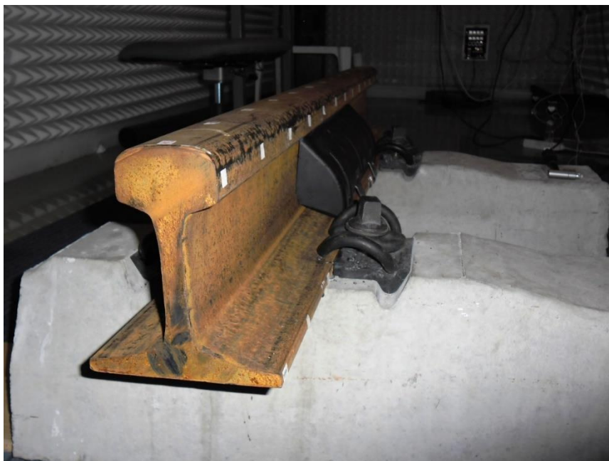
15. kép STRAILastic_A_inox típusú kamraelem oldalról
