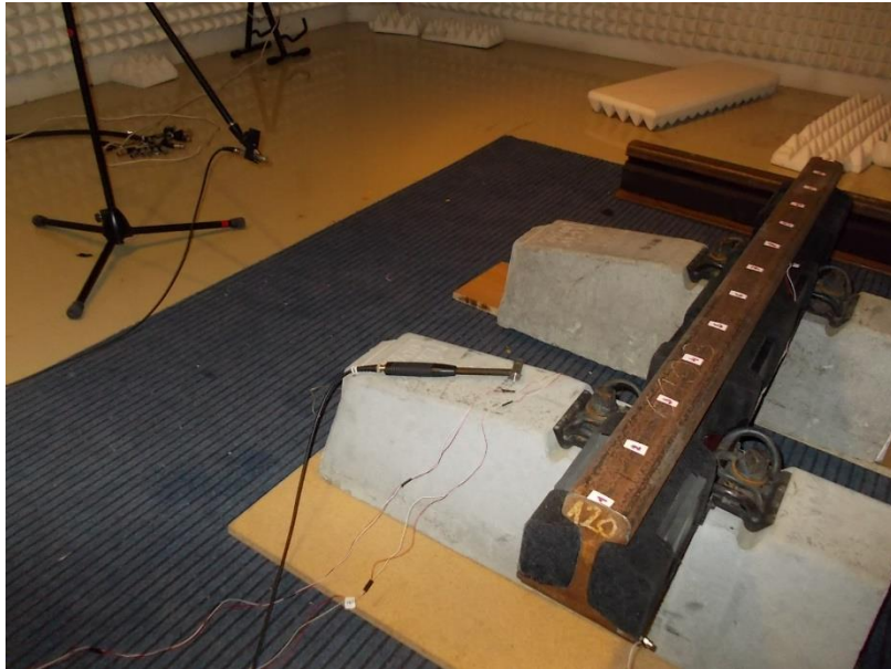
16. kép Mikrofon mérési helye
