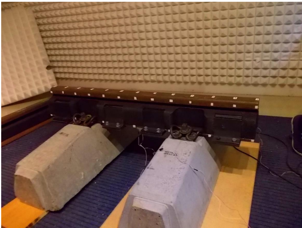
6. kép SOFIDON-T típusú rendszer szerelhető formában rögzítve a sínzálon
