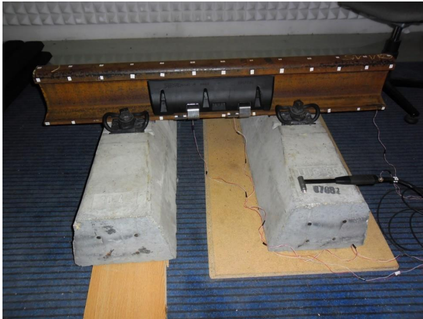
14. kép STRAILastic_A_inox típusú kamraelem a laborban összeállított rendszerre felhelyezve
