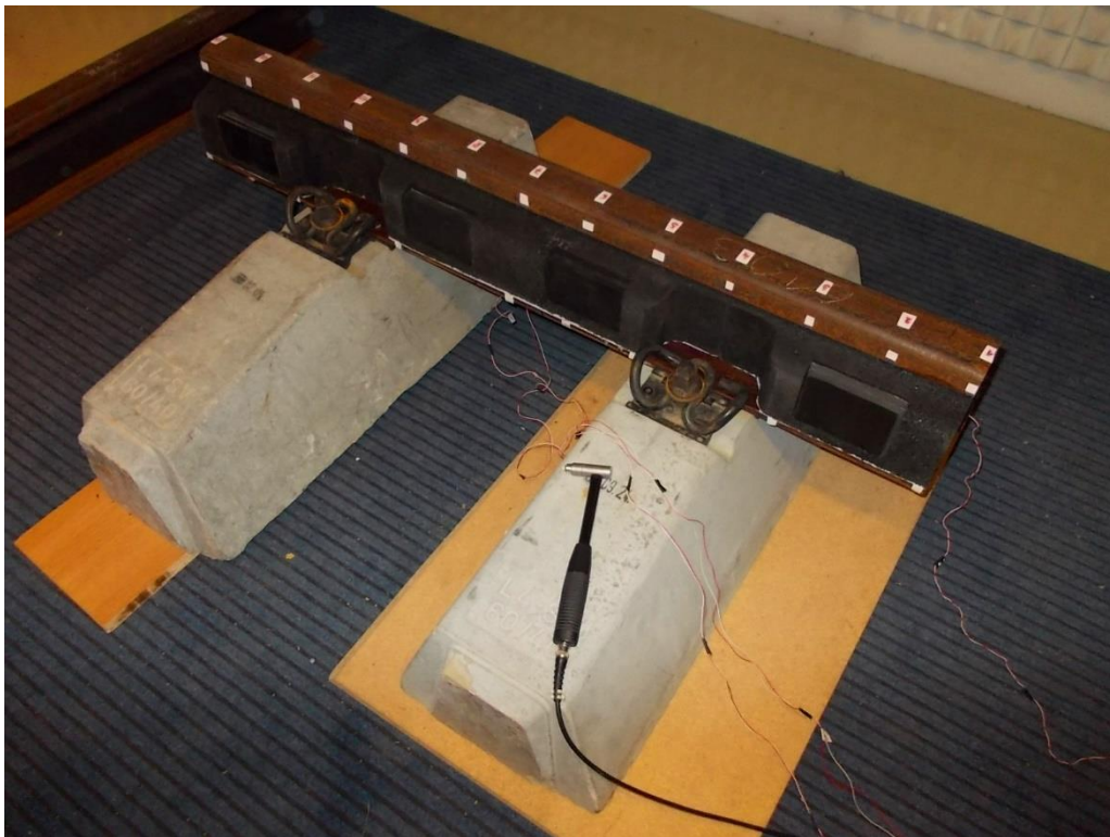
9. kép SOFIDON-T típusú rendszer ragasztással rögzítve a sínszálon
