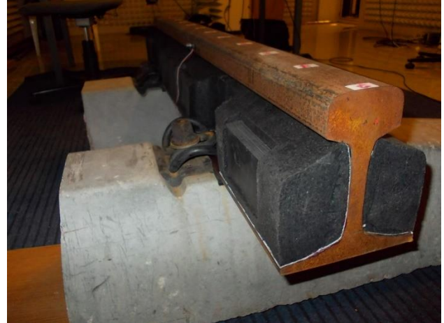
7-8. kép SOFIDON-T típusú kamraelem szerelve és ragasztott módszerrel felhelyezve
