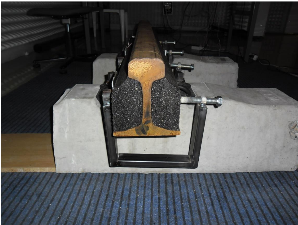
11. kép GRANUFLEX kamraelem szorítókkal felhelyezve, oldalról
