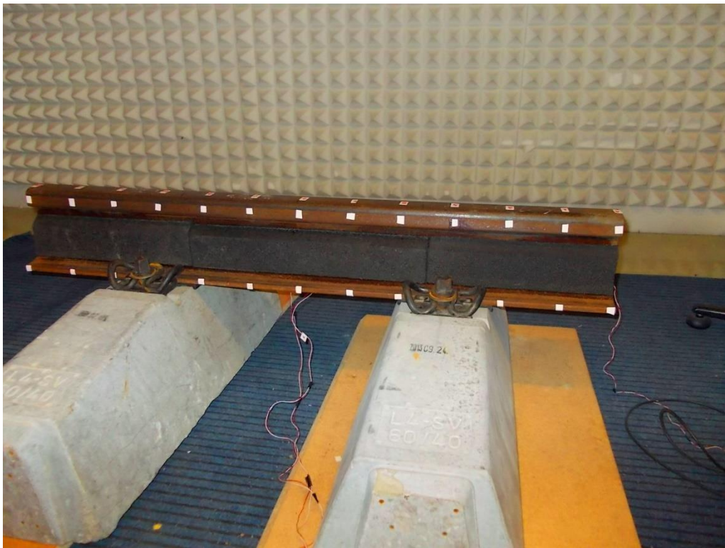
5. kép A laboratóriumban összeállított rendszer a SOFIDON-F típusú kamraelemmel
