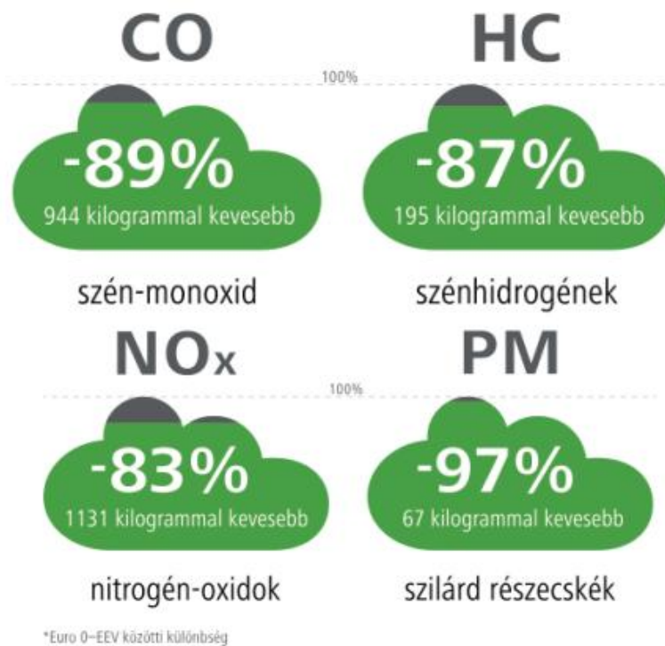
31. ábra: Az új Mercedes buszok az EEV normával is közel 90%-al kevesebb szénmonoxidot bocsátanak ki az öreg Ikarusokhoz képest. (Kép forrása: BKK Zrt.)
