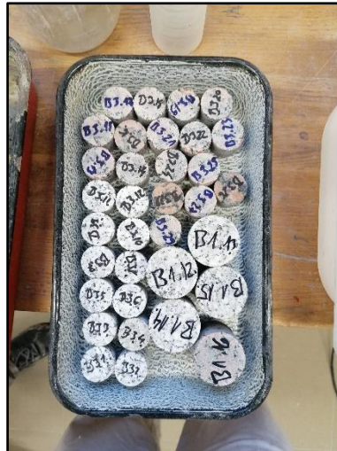
10.ábra. Húzóvizsgálat próbatestjei.
