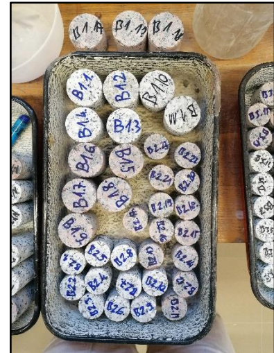
11.ábra. Húzóvizsgálat próbatestjei.
