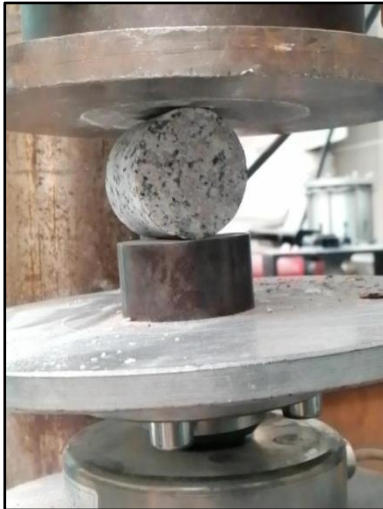
9.ábra. Brazil vizsgálat, próbatest elhelyezkedése a törőgépből
