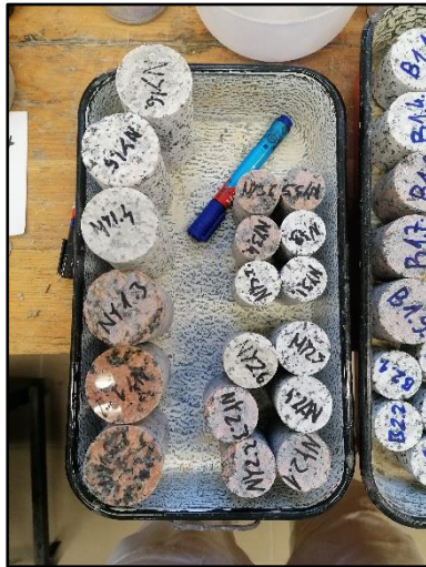
13.ábra. Nyomó vizsgálat próbatestjei.
