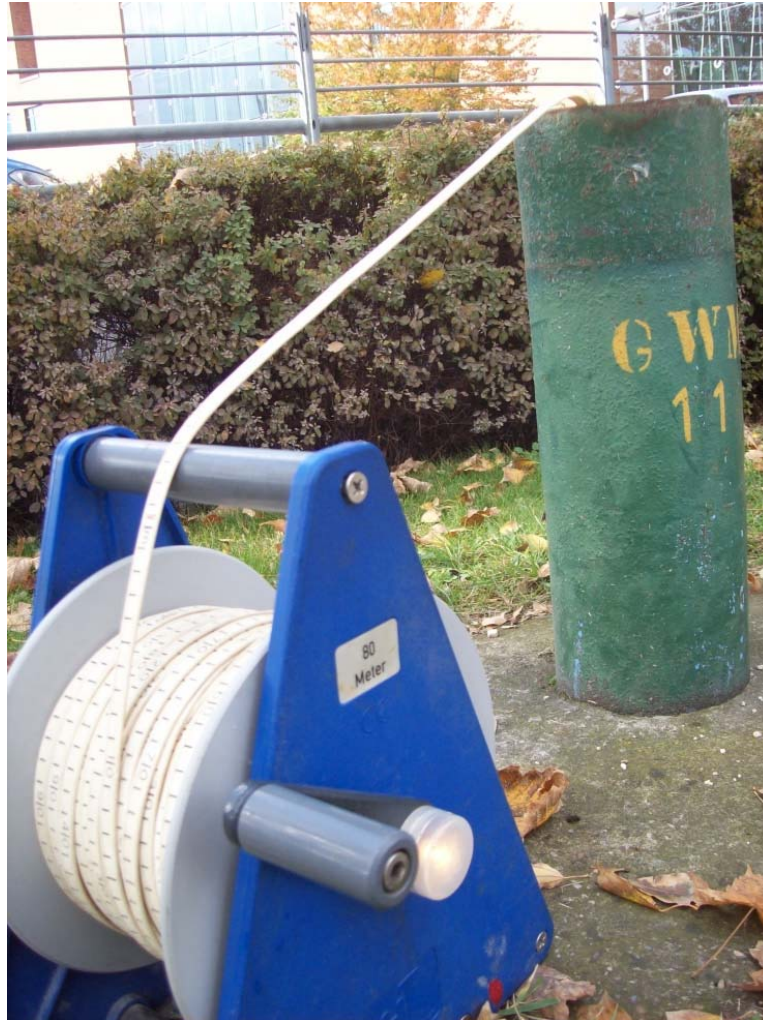
2. kép A fényjelzős talajvízszintmérő műszer
