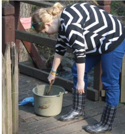
7. ábra: Kémiai vízhozam-mérés előkészítése, később beadagolás a hídról
